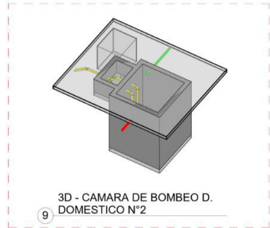
Vista 3D – Ejemplo Cámara de Bombeo
