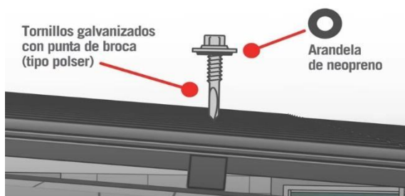
IMAGEN 07 (ALUZINC TR-4 – Tipo de tornillo)
