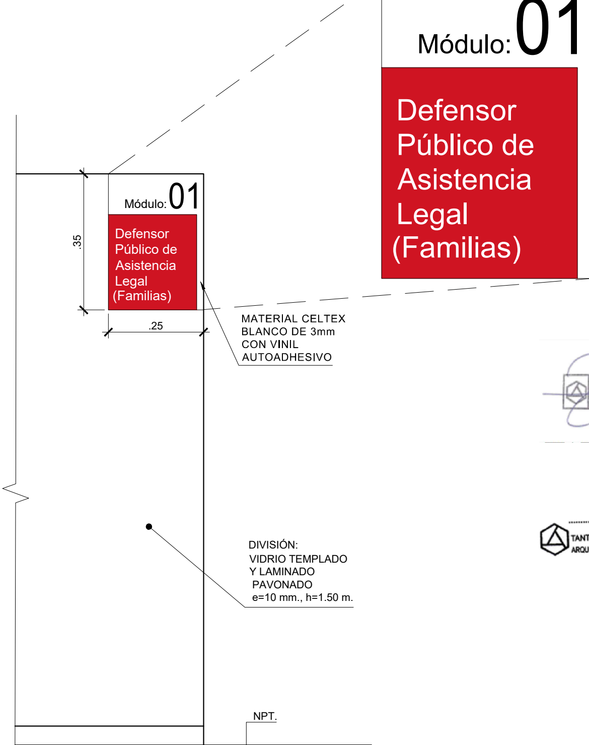
DETALLE DE COLOCADO SEÑAL IDENTIFICATIVO ESC. 1/10
