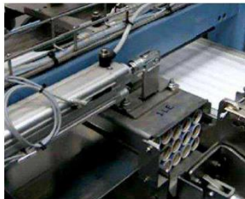
Figura 4. Foto referencial apilador de cartuchos y transferencia de cartuchos a cajas (dentro de maquina encajonadora de cartuchos).
