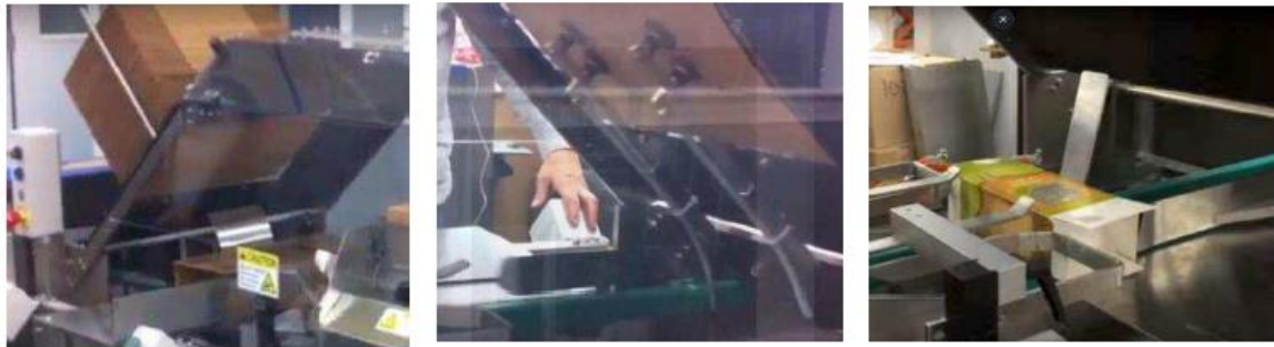
Figura 3. Foto referencial almacén y posicionador de cajas (dentro de máquina encajonadora de cartuchos).
