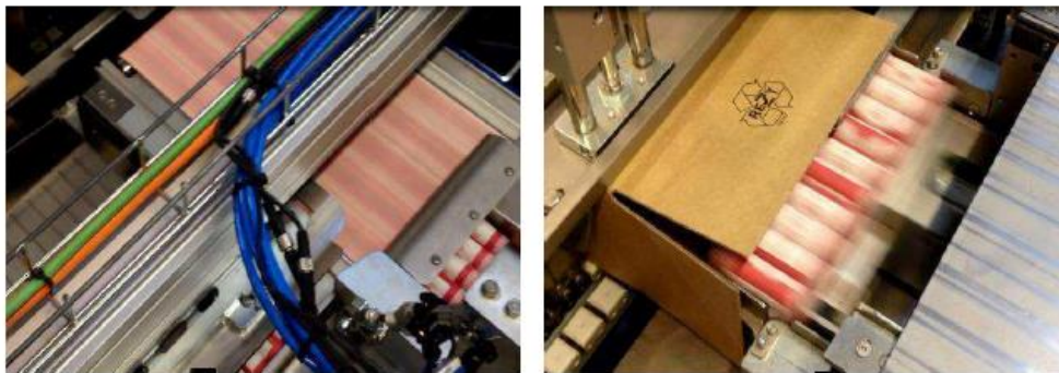
Figura 3. Foto referencial almacén y posicionador de cajas (dentro de máquina encajonadora de cartuchos).
