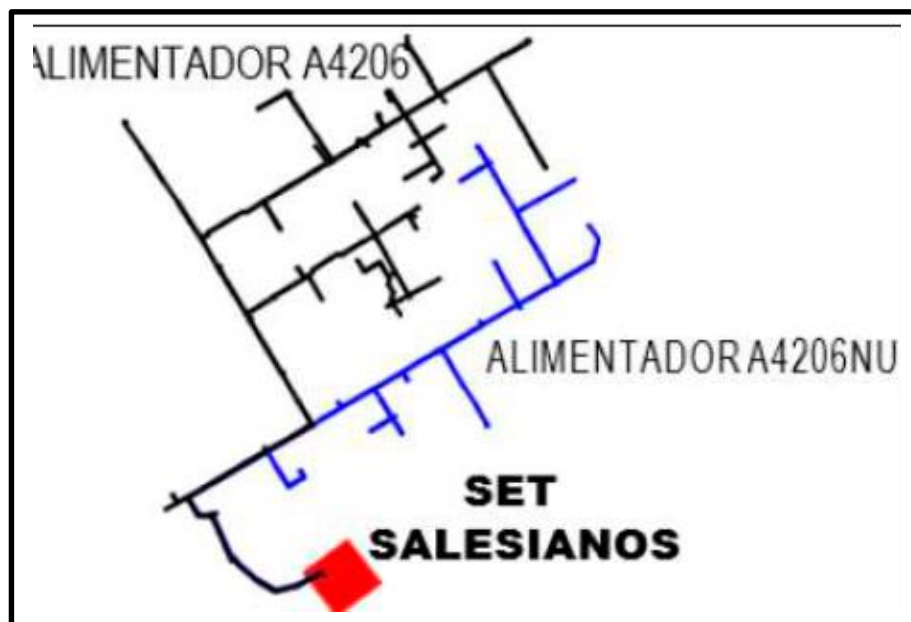
Fig. N° 13: Redes finales en 10 kV después de la reconfiguración y división del alimentador A4206
