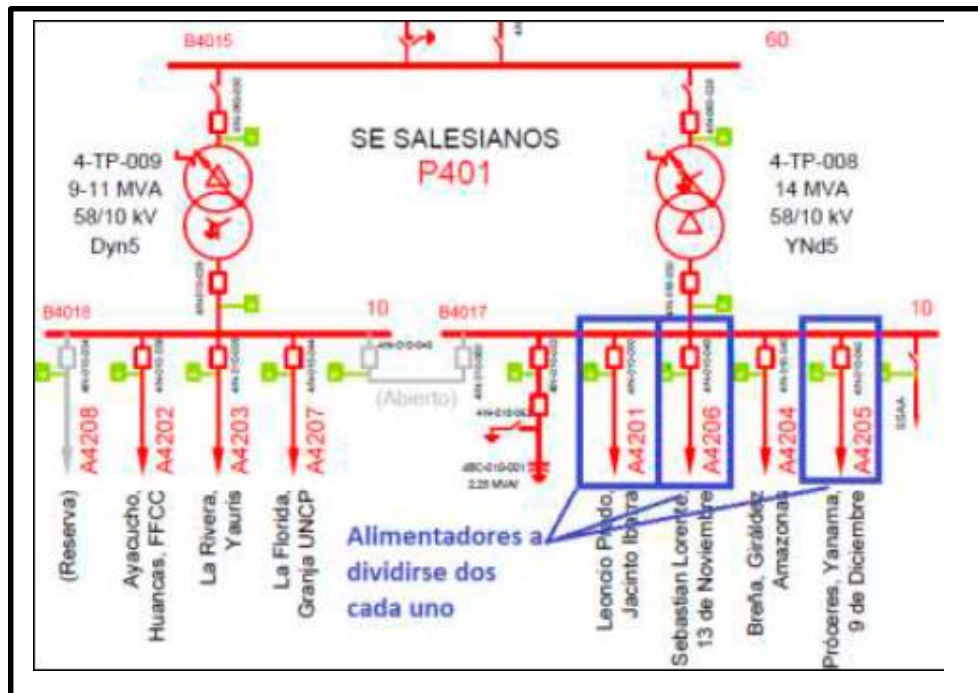
Fig. N° 10: Diagrama Unifilar de la SET Salesianos
