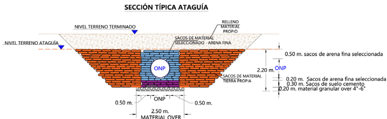
Gráfico N° 89. Sección típica Ataguía
