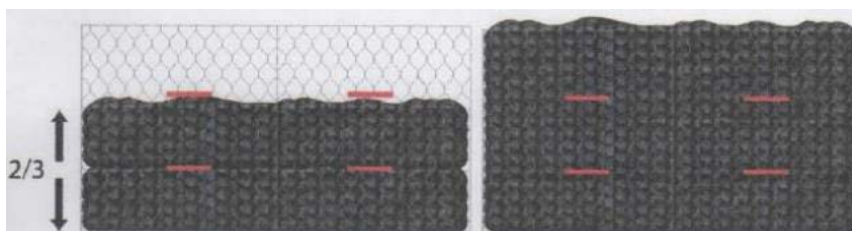
Posición de los tensores en Gavión.
