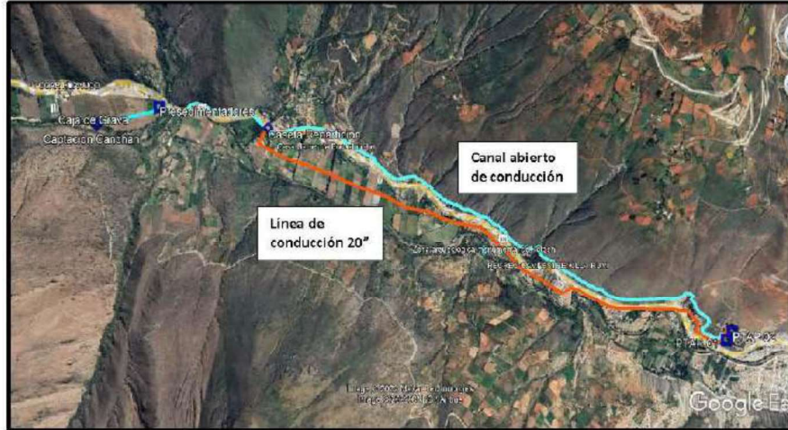
Ilustración 11: Líneas de conducción de agua cruda
