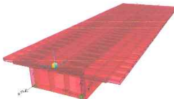
Figura N° 14: Reacciones en los apoyos debido a cargas de peso propio DC.
