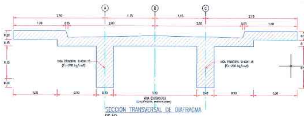
Figura N° 11: Geometría y distribución estructural de elementos de superestructura
