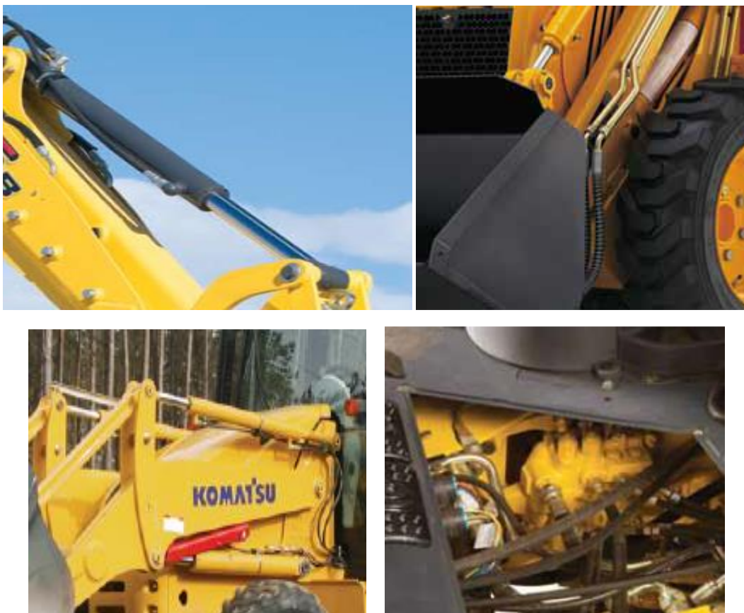
Ejemplos de diversos pistones hidráulicos y mangueras hidráulicas
