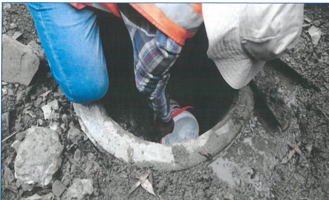
Imagen N° 2.5: Aforo de la captación existente Intipa Pupun 01 localidad de Ccochancay.
