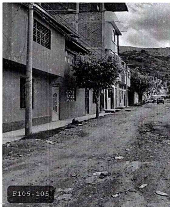
Fotografía N° 4 Vista Calle cruz de chalpon Cuadra N° 03. Se aprecia la erosión de la calle debido a la presencia de aguas pluviales, producto de una carencia de drenaje pluvial. Presencia de postes de alumbrado eléctrico.
