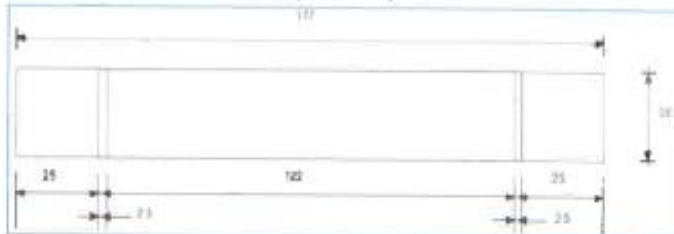
Figura 7: Regla graduada para ajustar la longitud de medida sobre la superficie de ensayo
