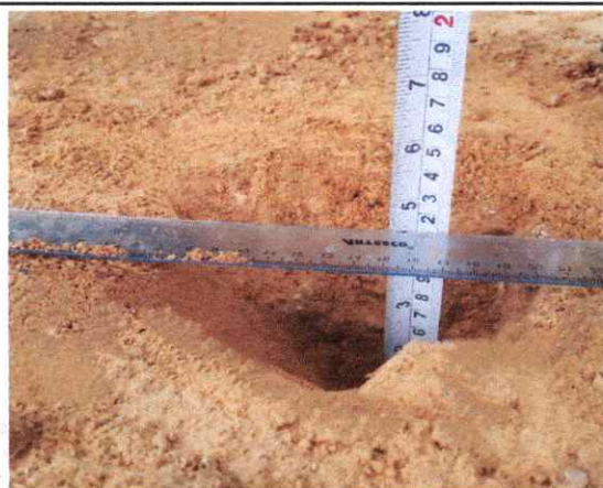
Foto 71: Espesor de la plataforma 0.10 mts. En el Km. 17+500
