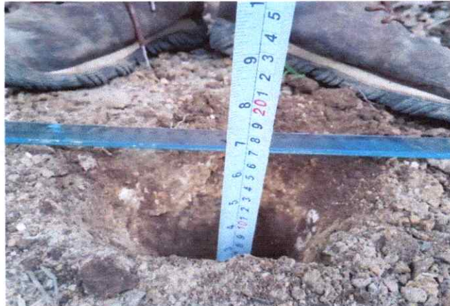
Foto 02: Espesor de la plataforma 0.08 mts. En el Km. 0+250
