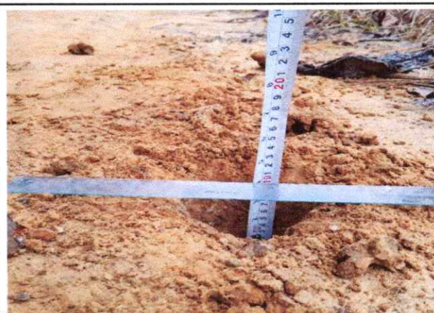
Foto 32: Espesor de la plataforma 0.10 mts. LI En el Km. 7+750
