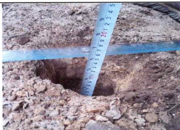
Foto 09: Espesor de la plataforma 0.08 mts. En el Km. 2+000
