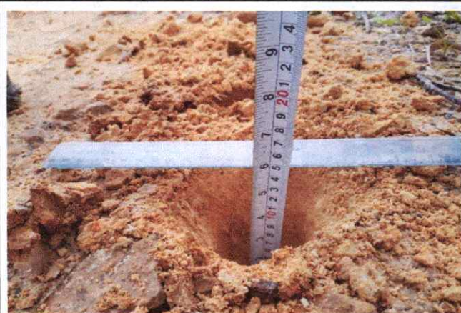
Foto 39: Espesor de la plataforma 0.10 mts. En el Km. 9+500
