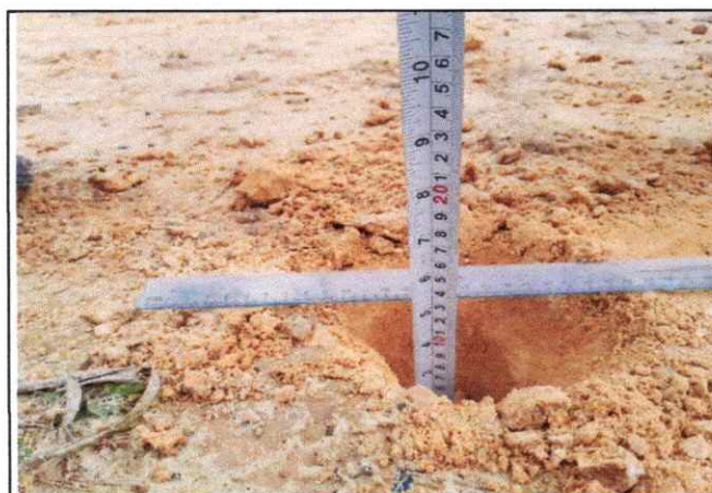
Foto 35: Espesor de la plataforma 0.10 mts. En el Km. 8+500
