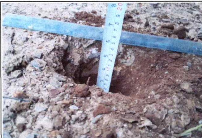
Foto 01: Espesor de la plataforma 0.08 mts. En el Km. 0+000
