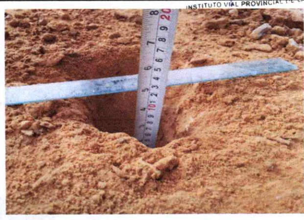
Foto 60: Espesor de la plataforma 0.10 mts. En el Km. 14+250.
