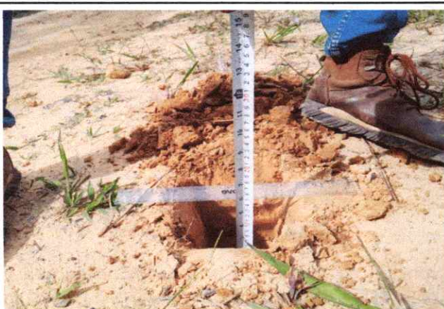
Foto 111: Espesor de la plataforma 0.10 mts.. En el Km. 27+500
