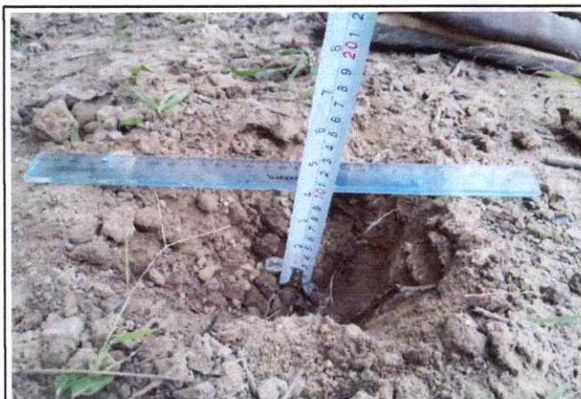
Foto 03: Espesor de la plataforma 0.08 mts. En el Km. 0+500
