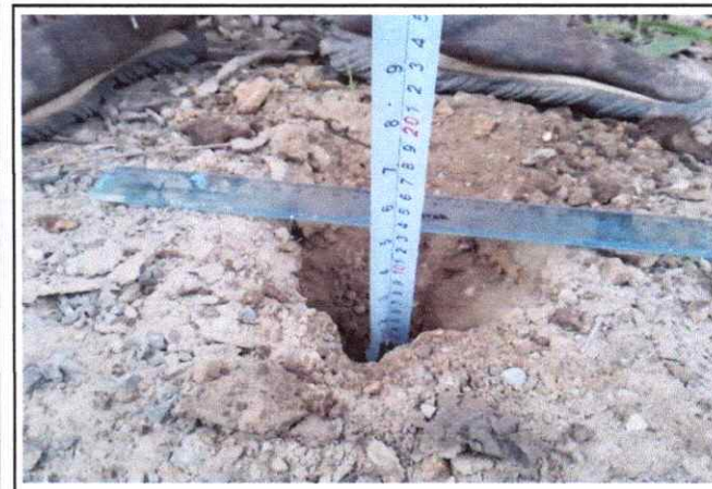
Foto 06: Espesor de la plataforma 0.08 mts. Casi no se nota en la muestra. En el Km. 1+250
