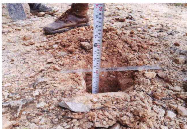
Foto 99: Espesor de la plataforma 0.10 mts. En el Km. 24+500
