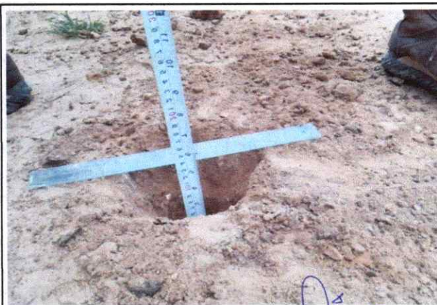
Foto 10: Espesor de la plataforma 0.08 mts. La mayor parte del terreno es arcilla. En el Km. 2+250
