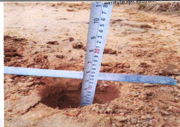
Foto 78: Espesor de la plataforma 0.10 mts. En el Km. 19+250.
