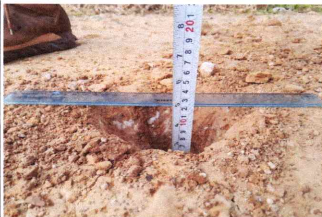
Foto 49: Espesor de la plataforma 0.10 mts. En el Km. 12+000.
