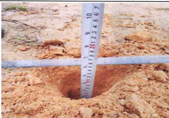
Foto 37: Espesor de la plataforma 0.10 mts. En el Km. 9+000.
