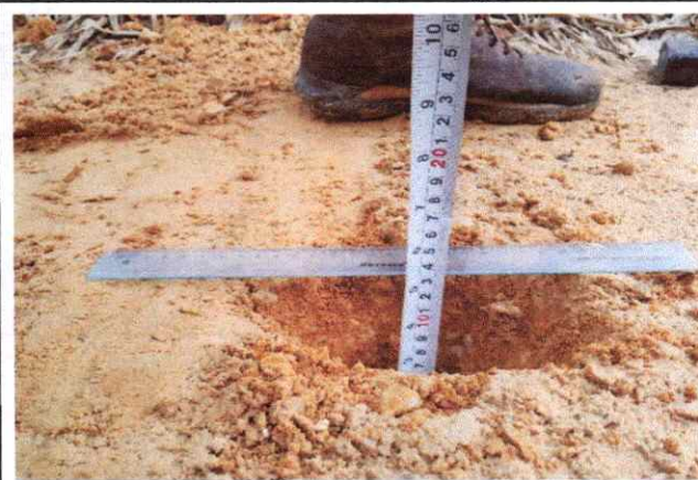
Foto 42: Espesor de la plataforma 0.10 mts. En el Km. 10+250
