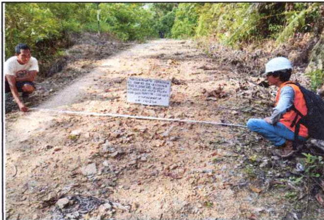
Foto 98: Se observa la topografía del terreno ondulado con una pendiente de 3% en el Km. 24+250
