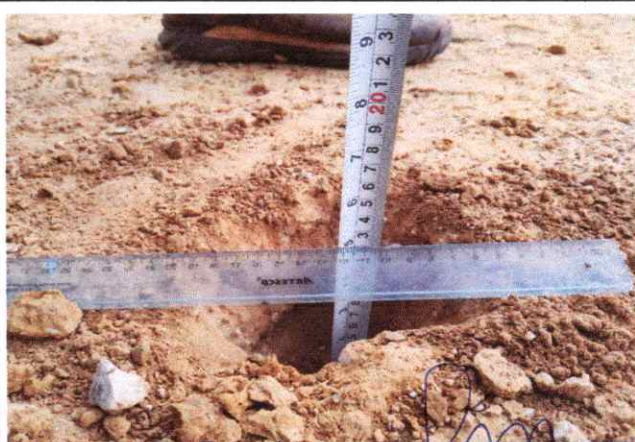
Foto 94: Espesor de la plataforma 0.10 mts. En el Km. 23+250
