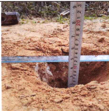
Foto 83: Espesor de la plataforma 0.10 mts. En el Km. 20+500
