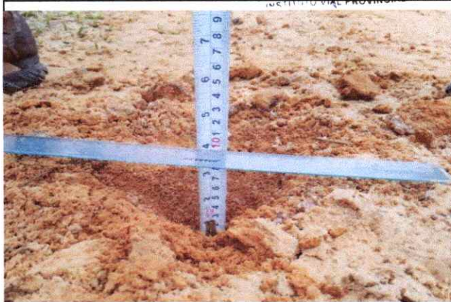
Foto 24: Espesor de la plataforma 0.10 mts. LD En el Km. 5+750
