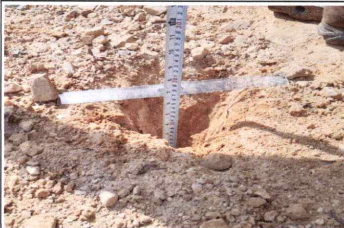
Foto 115: Espesor de la plataforma 0.07 mts. En el Km. 28+500. Se aprecia el afirmado delgado.
