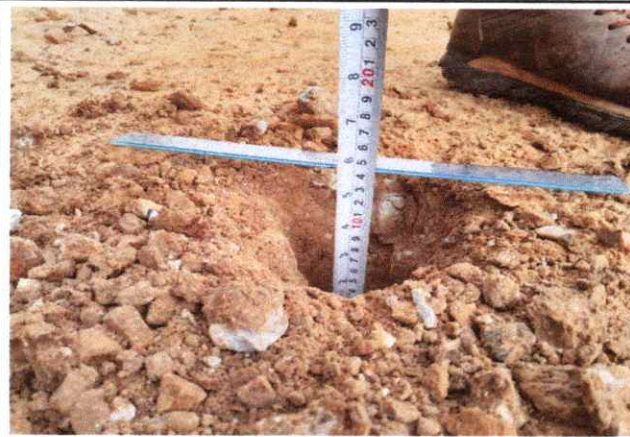
Foto 85: Espesor de la plataforma 0.10 mts. En el Km. 21+000.
