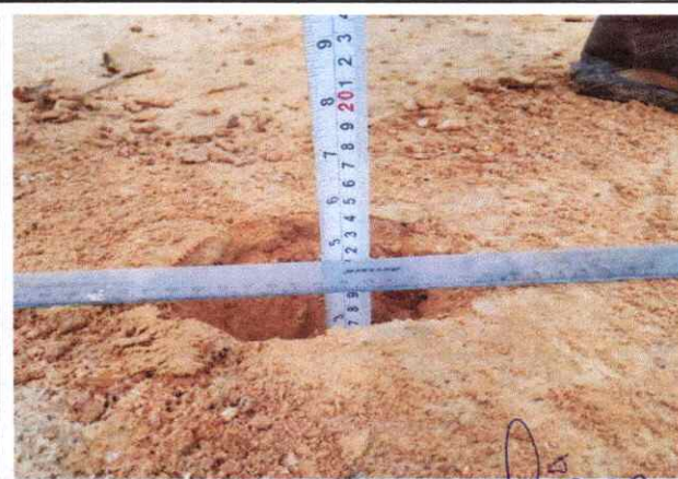
Foto 40: Espesor de la plataforma 0.10 mts. En el Km. 9+750.
