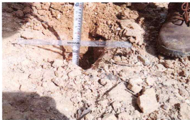
Foto 117: Espesor de la plataforma 0.06 mts. En el Km. 29+000
