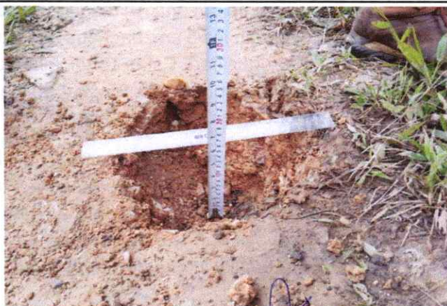
Foto 100: Espesor de la plataforma 0.10 mts. En el Km. 24+750
