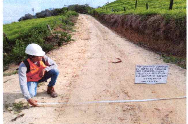
Foto 86: Se observa la topografía del terreno ondulado con una pendiente de 3% en el Km. 21+250
