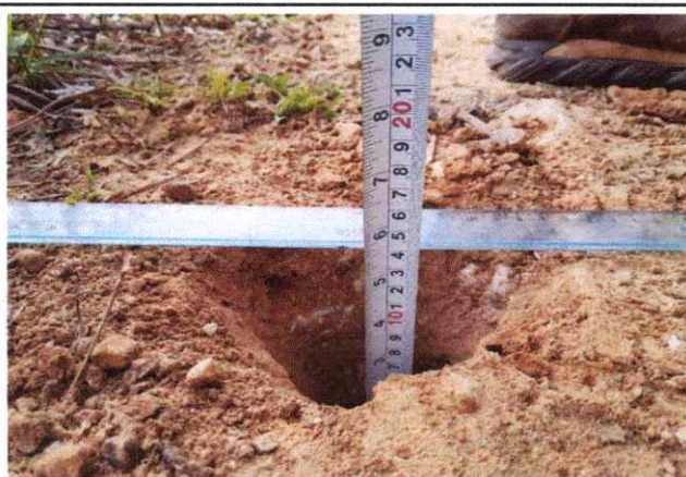
Foto 89: Espesor de la plataforma 0.10 mts. En el Km. 22+000
