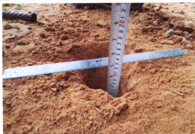
Foto 53: Espesor de la plataforma 0.10 mts. En el Km. 13+000
