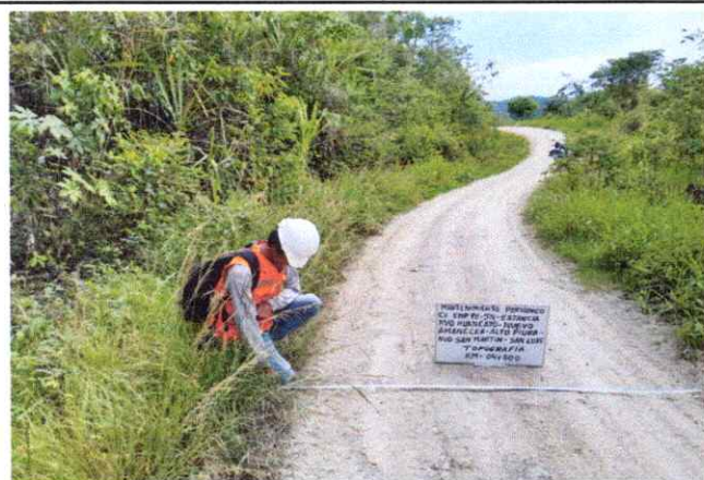
Foto 17: Se observa la topografía del terreno accidentado con una pendiente de 6% en el Km. 04+000
