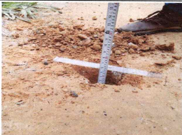
Foto 61: Espesor de la plataforma 0.10 mts. En el Km. 15+000.
