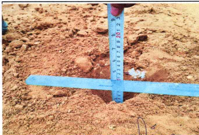
Foto 22: Espesor de la plataforma 0.10 mts. EJE En el Km. 5+250
