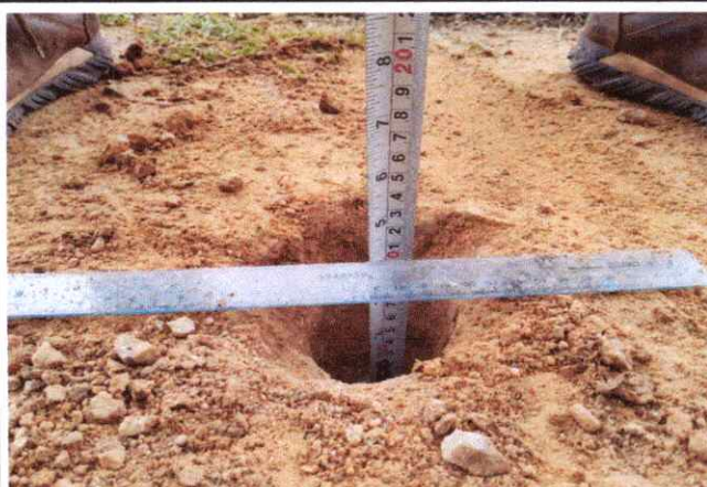
Foto 93: Espesor de la plataforma 0.10 mts. En el Km. 23+000
