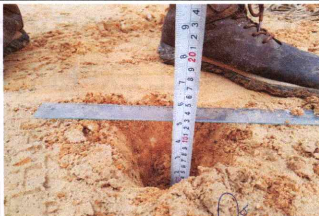
Foto 46: Espesor de la plataforma 0.10 mts. En el Km. 11+250
