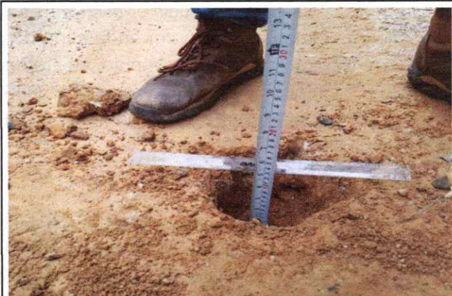
Foto 114: Espesor de la plataforma 0.10 mts. En el Km. 28+223.
