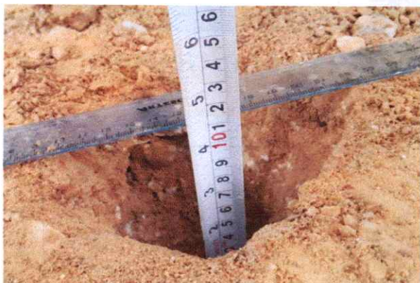
Foto 91: Espesor de la plataforma 0.10 mts. En el Km. 22+500. Se aprecia el afirmado delgado.
