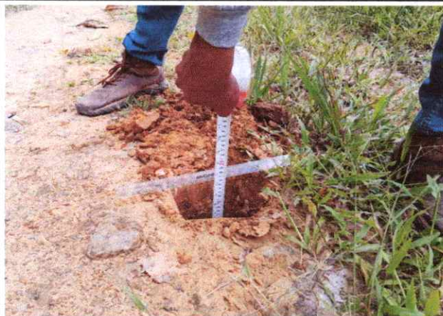
Foto 109: Espesor de la plataforma 0.10 mts. En el Km. 27+000.
