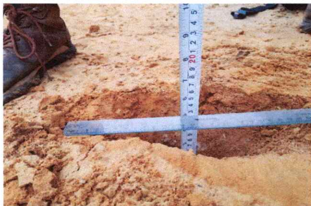
Foto 25: Espesor de la plataforma 0.10 mts. EJE En el Km. 6+000
