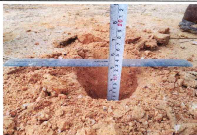
Foto 63: Espesor de la plataforma 0.10 mts. En el Km. 15+500
