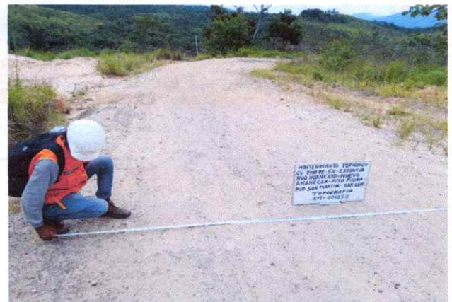
Foto 02: Se observa la topografía del terreno ondulado con una pendiente de 3% en el Km. 0+250
