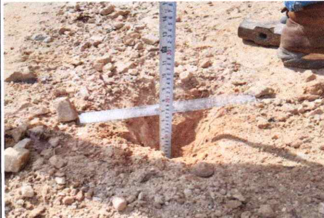
Foto 54: Espesor de la plataforma 0.10 mts. En el Km. 13+250.
