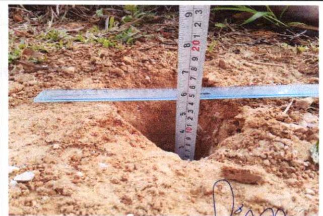
Foto 88: Espesor de la plataforma 0.10 mts. En el Km. 21+750 Ing. Marco Tulio Reátegui Acedo JEFE DE OPERACIONES CIP.: N° 220015 INSTITUTO VIAL PROVINCIAL DE LAMAS
