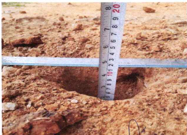
Foto 52: Espesor de la plataforma 0.10 mts. En el Km. 12+750
