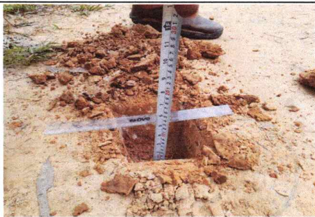
Foto 104: Espesor de la plataforma 0.10 mts. En el Km. 25+750
