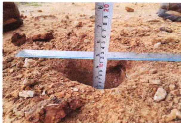
Foto 92: Espesor de la plataforma 0.10 mts. En el Km. 22+750
