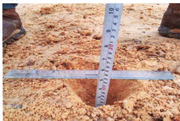
Foto 66: Espesor de la plataforma 0.10 mts. En el Km. 16+250.
