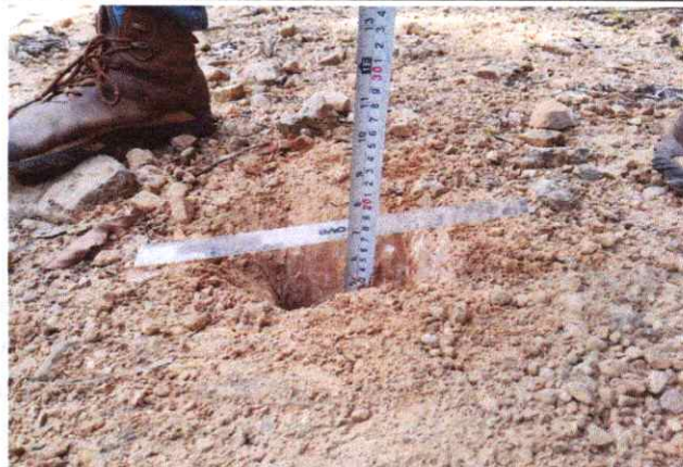
Foto 98: Espesor de la plataforma 0.10 mts. En el Km. 24+250
