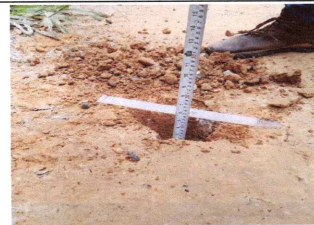
Foto 59: Espesor de la plataforma 0.10 mts. En el Km. 14+000
