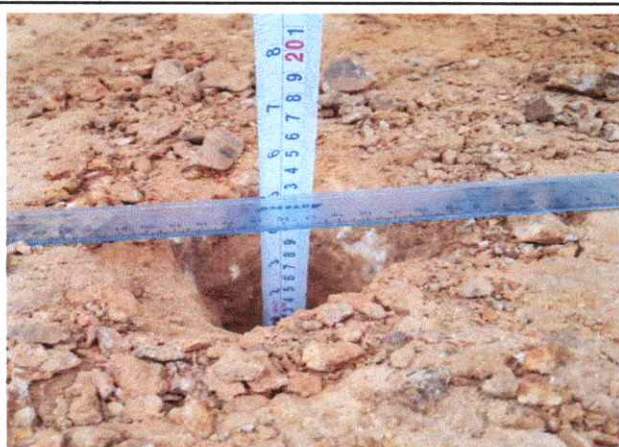
Foto 69: Espesor de la plataforma 0.10 mts. En el Km. 17+000
