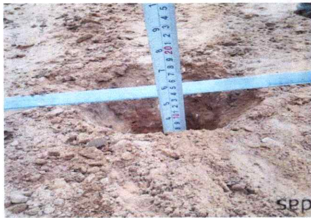
Foto 13: Espesor de la plataforma 0.08 mts. Se observa una fina capa de afirmado. En el Km. 3+000
