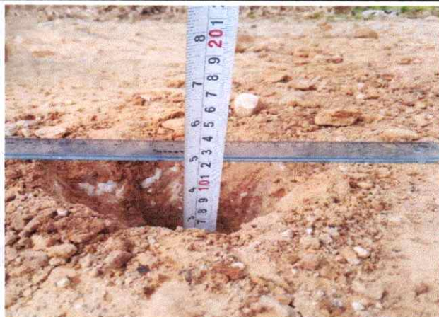
Foto 56: Espesor de la plataforma 0.10 mts. En el Km. 13+270
