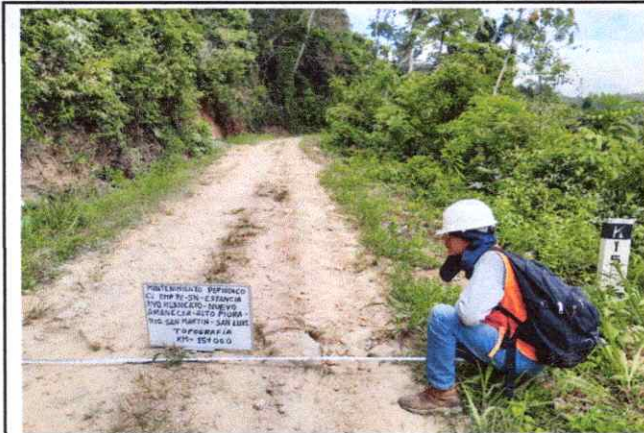
Foto 61: Se observa la topografía del terreno ondulado con una pendiente de 4% en el Km. 15+000
