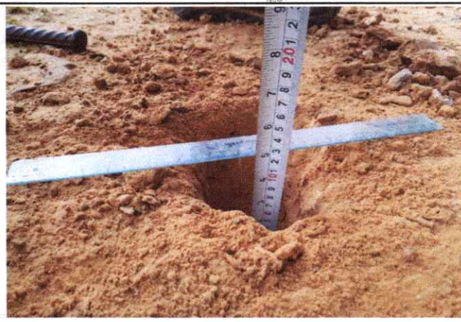
Foto 84: Espesor de la plataforma 0.10 mts. En el Km. 20+750.
