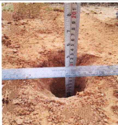
Foto 75: Espesor de la plataforma 0.10 mts. En el Km. 18+500
