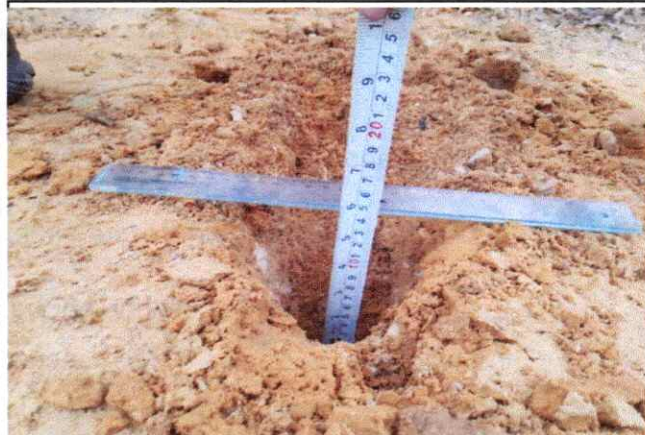
Foto 30: Espesor de la plataforma 0.10 mts. LD En el Km. 7+250
