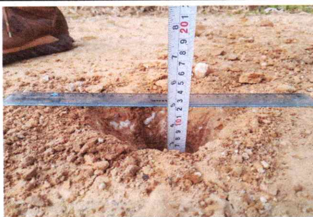
Foto 95: Espesor de la plataforma 0.10 mts. En el Km. 23+500
