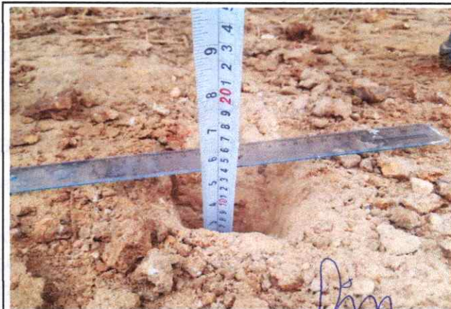
Foto 64: Espesor de la plataforma 0.10 mts. En el Km. 15+750
