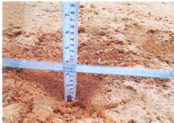
Foto 80: Espesor de la plataforma 0.10 mts. En el Km. 19+750
