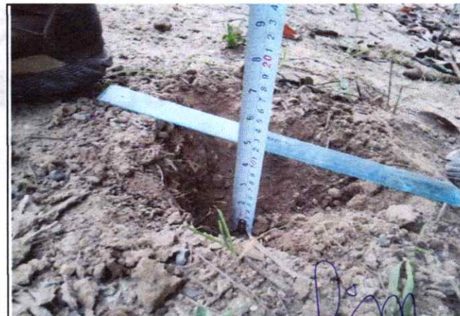
Foto 04: Espesor de la plataforma 0.08 mts. En el Km. 0+750 Ing. Marco Tulio Reátegui Acedo JEFE DE OPERACIONES CIP.: N° 220015 INSTITUTO VIAL PROVINCIAL DE LAMAS
