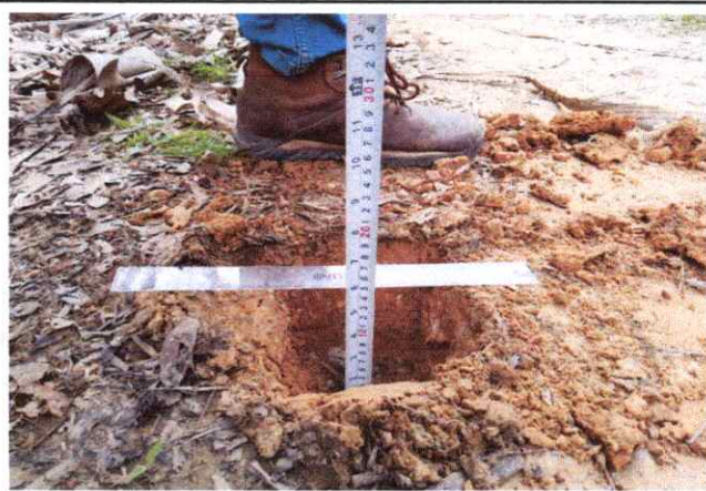
Foto 110: Espesor de la plataforma 0.10 mts. En el Km. 27+250.
