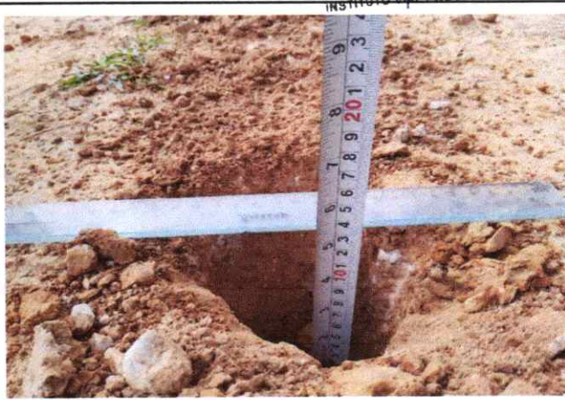
Foto 48: Espesor de la plataforma 0.10 mts. En el Km. 11+750.
