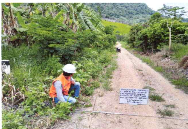
Foto 33: Se observa la topografía del terreno ondulado con una pendiente de 8% en el Km. 08+000
