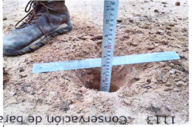
Foto 14: Espesor de la plataforma casi imperceptible de 0.08 mts. En el Km. 3+250
