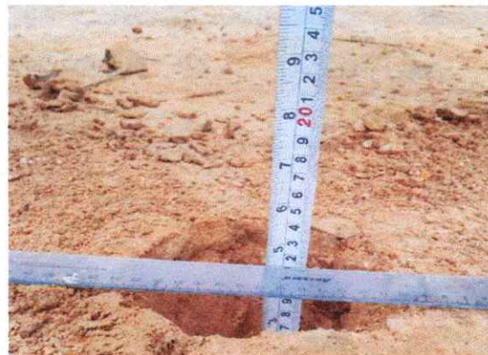
Foto 74: Espesor de la plataforma 0.10 mts. En el Km. 18+250
