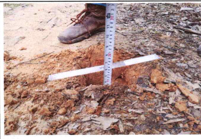
Foto 108: Espesor de la plataforma 0.10 mts. En el Km. 26+750.
