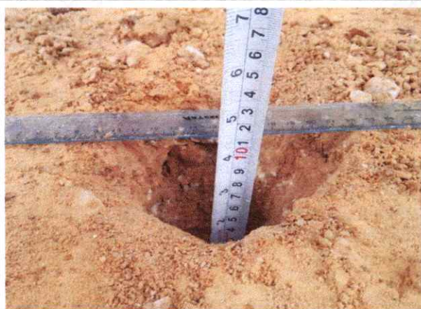
Foto 81: Espesor de la plataforma 0.10 mts. En el Km. 20+000
