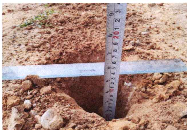
Foto 51: Espesor de la plataforma 0.10 mts. En el Km. 12+500
