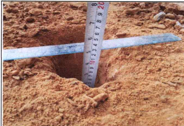
Foto 62: Espesor de la plataforma 0.10 mts. En el Km. 15+250
