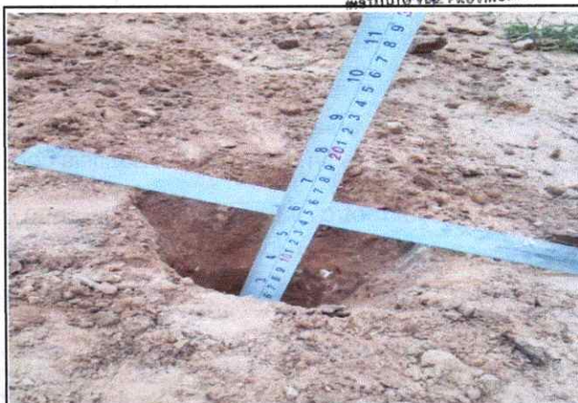
Foto 12: Espesor de la plataforma 0.08 mts. En el Km. 2+750
