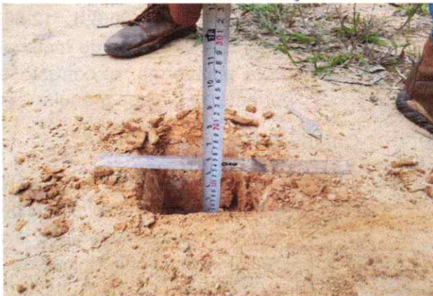
Foto 102: Espesor de la plataforma 0.10 mts. En el Km. 25+250.
