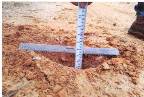
Foto 50: Espesor de la plataforma 0.10 mts. En el Km. 12+250
