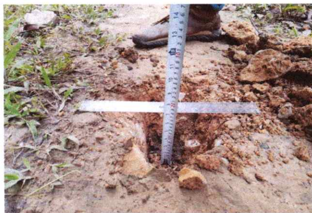
Foto 101: Espesor de la plataforma 0.10 mts. En el Km. 25+000
