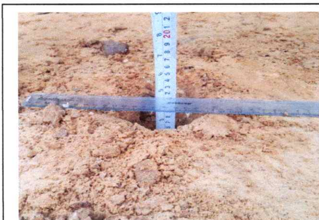
Foto 33: Espesor de la plataforma 0.10 mts. LD En el Km. 8+000
