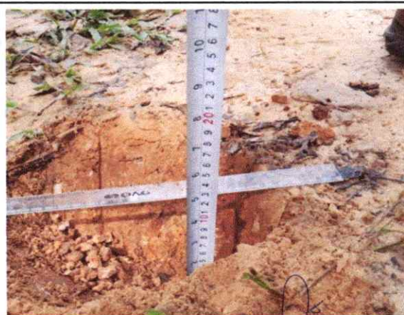
Foto 106: Espesor de la plataforma 0.10 mts. En el Km. 26+250
