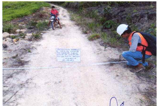
Foto 94: Se observa la topografía del terreno ondulado con una pendiente de 6% en el Km. 23+250
