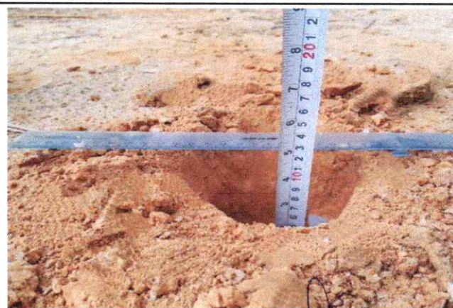
Foto 70: Espesor de la plataforma 0.10 mts. En el Km. 17+250
