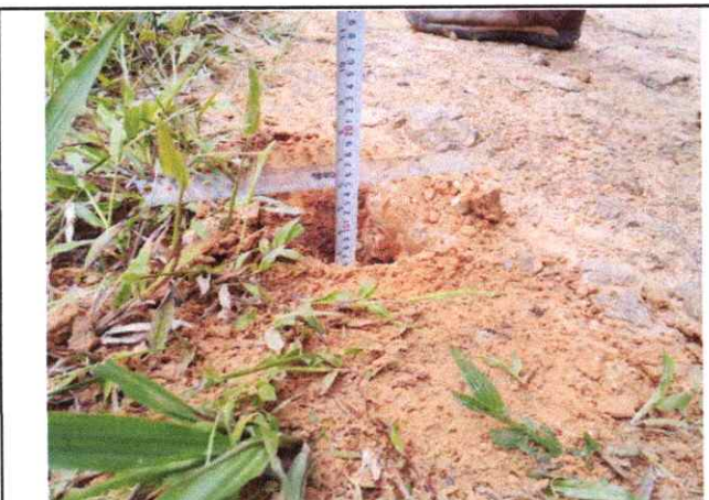
Foto 107: Espesor de la plataforma 0.10 mts. En el Km. 26+500
