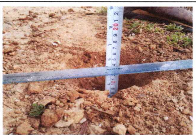
Foto 90: Espesor de la plataforma 0.10 mts. En el Km. 22+250. Se puede ver que el afirmado es delgado.
