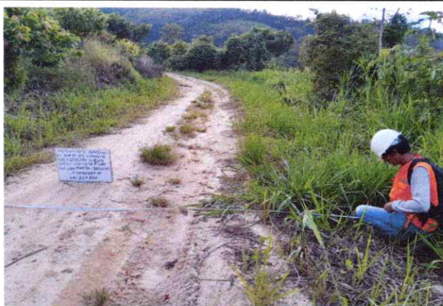
Foto 67: Se observa la topografía del terreno ondulado con una pendiente de 4% en el Km. 16+500
