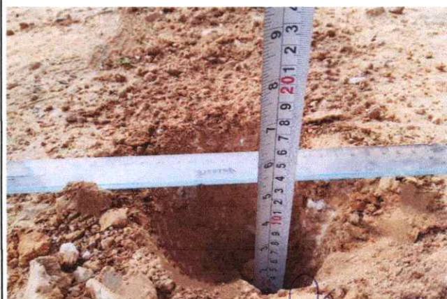
Foto 76: Espesor de la plataforma 0.10 mts. En el Km. 18+750
