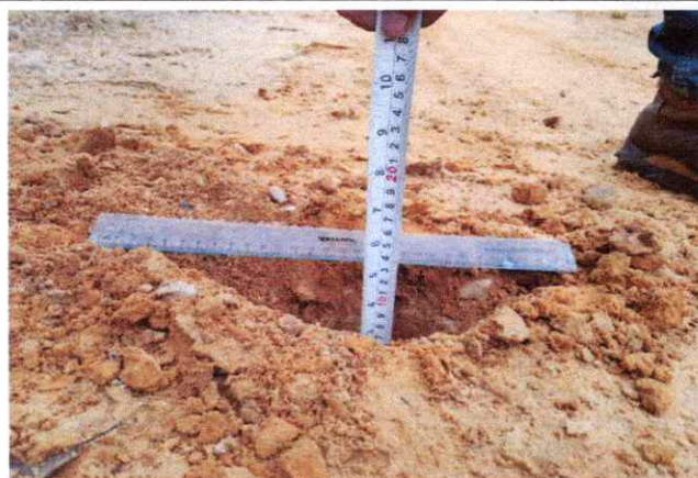
Foto 29: Espesor de la plataforma 0.10 mts. LD En el Km. 7+000
