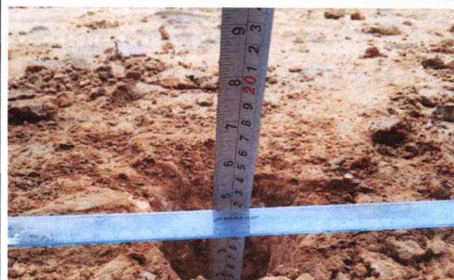
Foto 68: Espesor de la plataforma 0.10 mts. En el Km. 16+750
