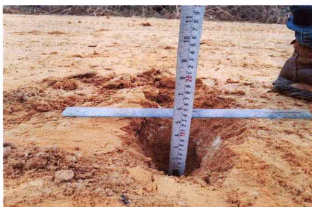
Foto 27: Espesor de la plataforma 0.10 mts. LI En el Km. 6+500
