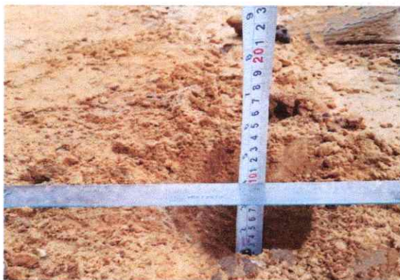
Foto 79: Espesor de la plataforma 0.10 mts. En el Km. 19+500.
