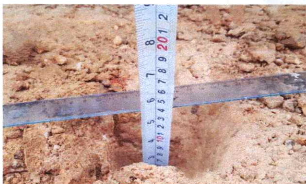
Foto 73: Espesor de la plataforma 0.10 mts. En el Km. 18+000.
