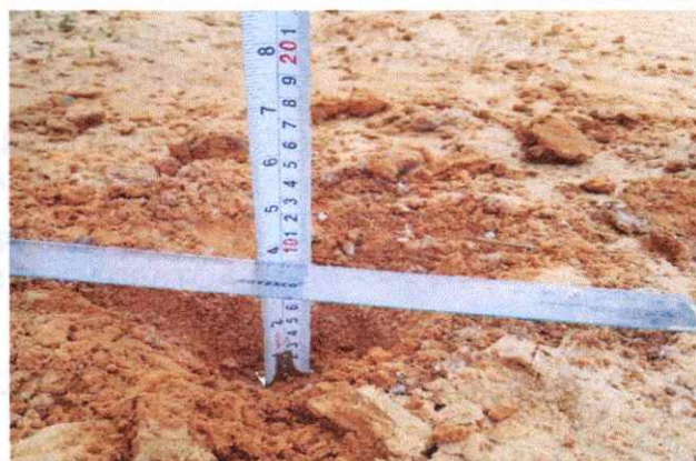
Foto 26: Espesor de la plataforma 0.10 mts. LD En el Km. 6+250
