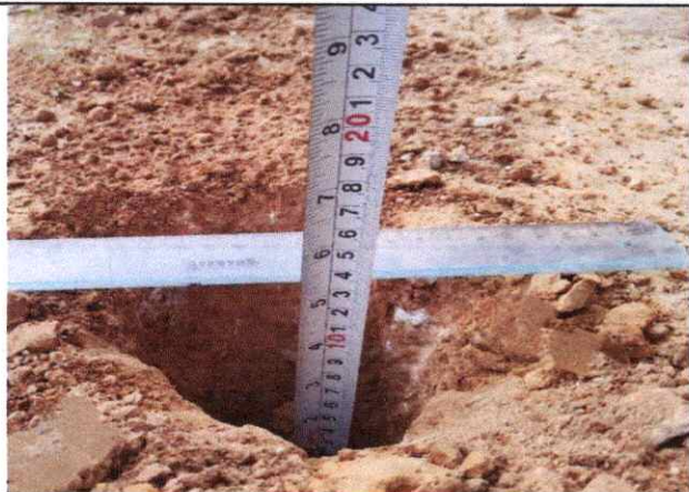
Foto 55: Espesor de la plataforma 0.10 mts. En el Km. 13+500.
