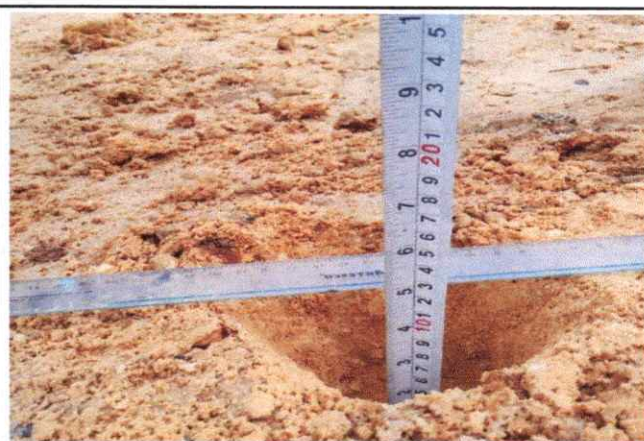
Foto 38: Espesor de la plataforma 0.10 mts. En el Km. 9+250
