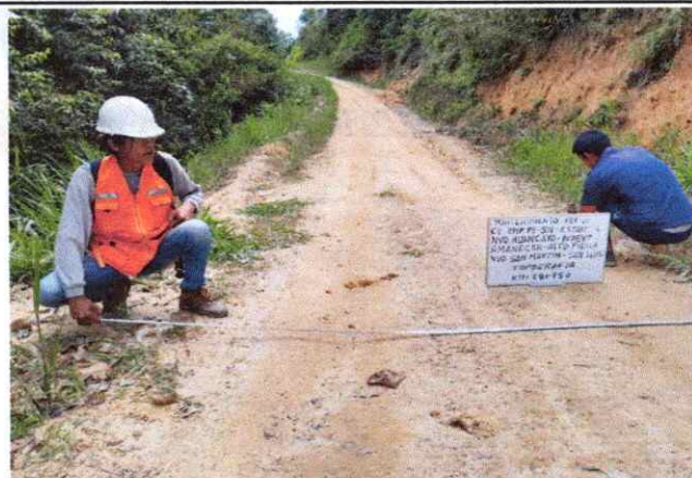
Foto 116: Se observa la topografía del terreno ondulado con una pendiente de 3% en el Km. 28+223
