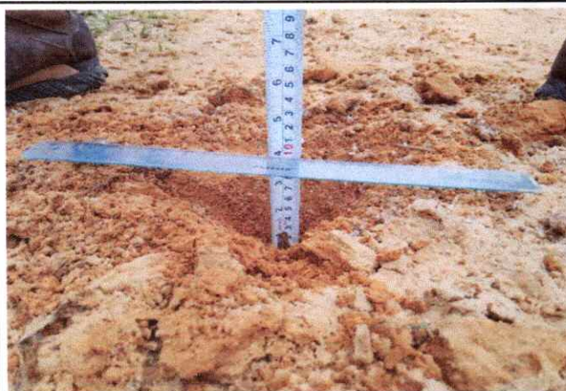
Foto 23: Espesor de la plataforma 0.10 mts. LI En el Km. 5+500
