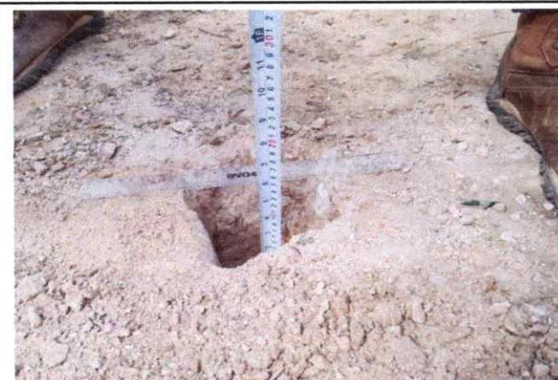
Foto 113: Espesor de la plataforma 0.10 mts. En el Km. 28+000.
