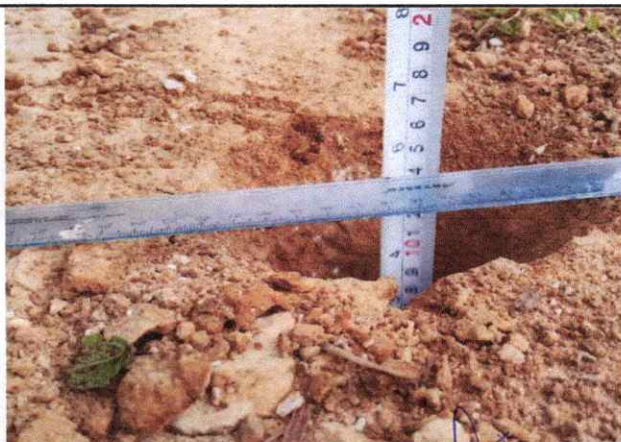
Foto 58: Espesor de la plataforma 0.10 mts. En el Km. 13+750
