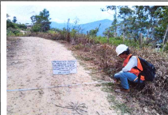
Foto 81: Se observa la topografía del terreno ondulado con una pendiente de 6% en el Km. 20+000
