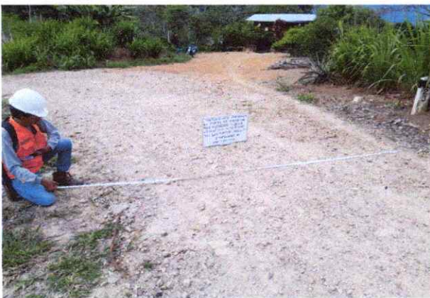
Foto 93: Se observa la topografía del terreno ondulado con una pendiente de 6% en el Km. 23+000
