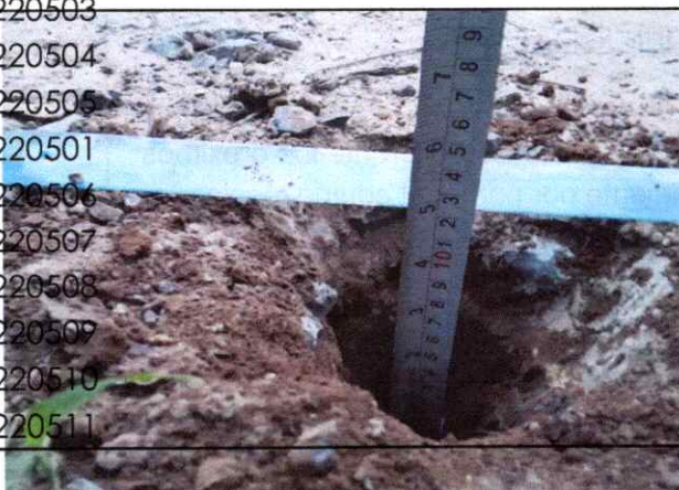
Foto 11: Espesor de la plataforma 0.08 mts. En el Km. 2+500
