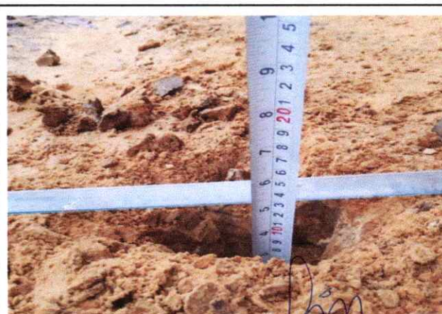
Foto 34: Espesor de la plataforma 0.10 mts. EJE En el Km. 8+250 Ing. Marco Tulio Reátegui Acedo JEFE DE OPERACIONES CIP.: N° 220015 INSTITUTO VIAL PROVINCIAL DE LAMAS
