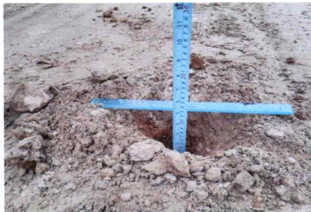
Foto 20: Espesor de la plataforma 0.08 mts. LI En el Km. 4+750
