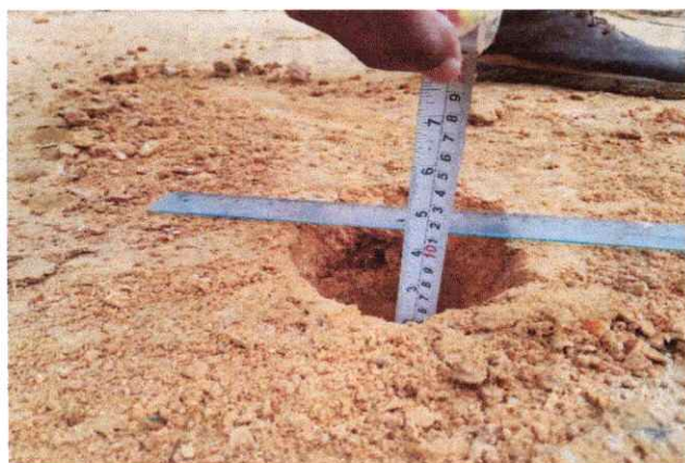
Foto 45: Espesor de la plataforma 0.10 mts. En el Km. 11+000
