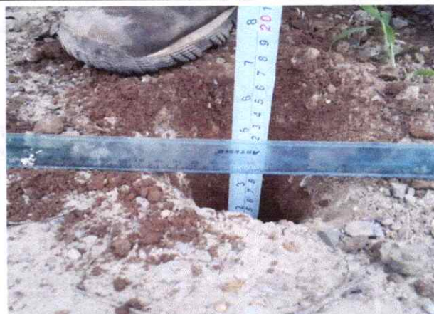
Foto 08: Espesor de la plataforma 0.08 mts. En el Km. 1+750
