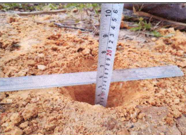
Foto 36: Espesor de la plataforma 0.10 mts. En el Km. 8+750
