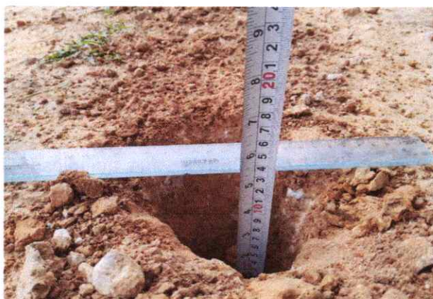
Foto 97: Espesor de la plataforma 0.10 mts. En el Km. 24+000.
