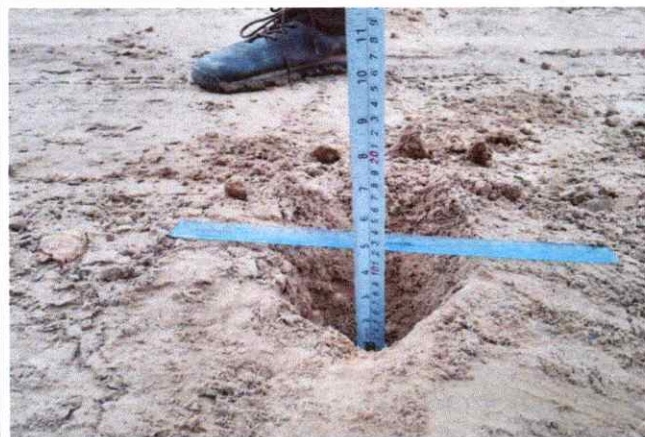
Foto 19: Espesor de la plataforma 0.08 mts. En el Km. 4+500
