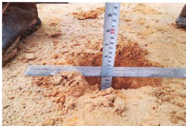
Foto 43: Espesor de la plataforma 0.10 mts. En el Km. 10+500.
