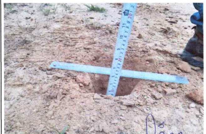
Foto 16: Espesor de la plataforma 0.08 mts. En el Km. 4+250
