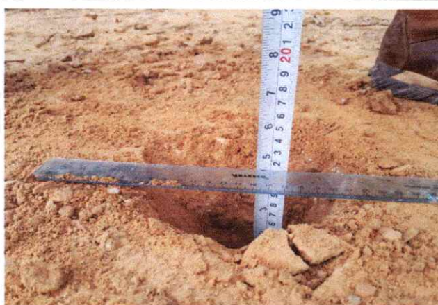
Foto 87: Espesor de la plataforma 0.10 mts. En el Km. 21+500
