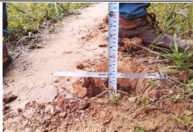
Foto 103: Espesor de la plataforma 0.10 mts. En el Km. 25+500.
