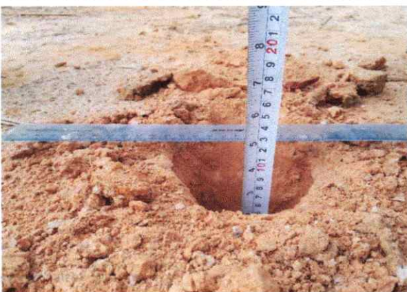
Foto 65: Espesor de la plataforma 0.10 mts. En el Km. 16+000.
