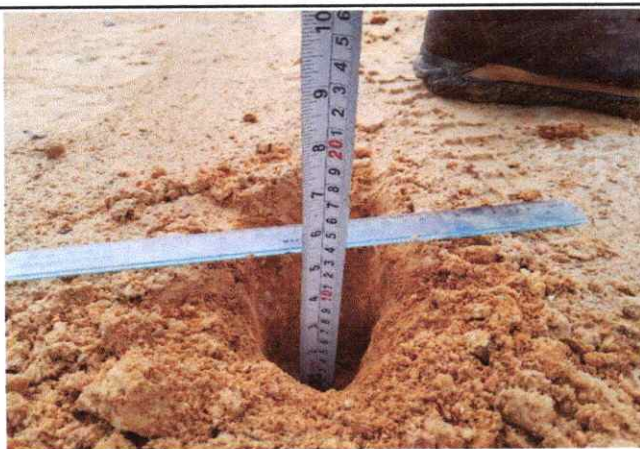
Foto 47: Espesor de la plataforma 0.10 mts. En el Km. 11+500
