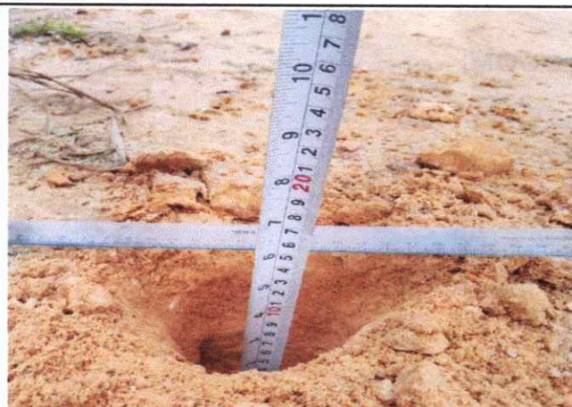
Foto 67: Espesor de la plataforma 0.10 mts. En el Km. 16+500.
