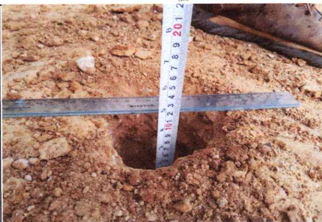
Foto 96: Espesor de la plataforma 0.10 mts. En el Km. 23+750.
