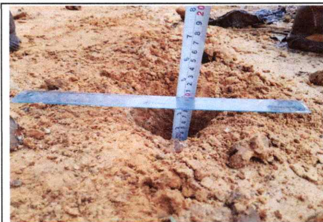
Foto 31: Espesor de la plataforma 0.10 mts. EJE En el Km. 7+500. Se puede ver que casi no existe afirmado.
