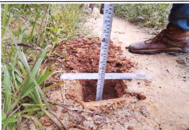
Foto 105: Espesor de la plataforma 0.10 mts. En el Km. 26+000
