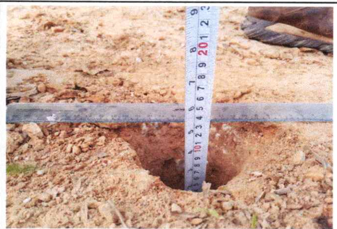
Foto 86: Espesor de la plataforma 0.10 mts. En el Km. 21+250
