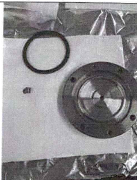
Foto 8: Cambio y suministro de los O-rings de la columna
