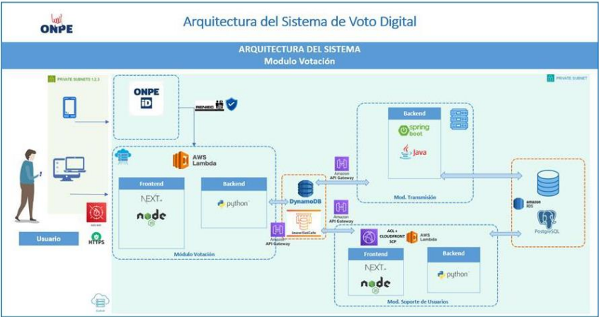
Ilustración 24. Diagrama de Arquitectura de Sistema de Voto Digital – Modulo votación
