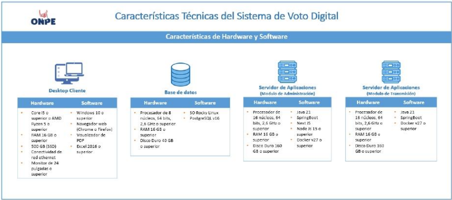
Ilustración 19. Características de Hardware y Software del Sistema de Voto Digital
