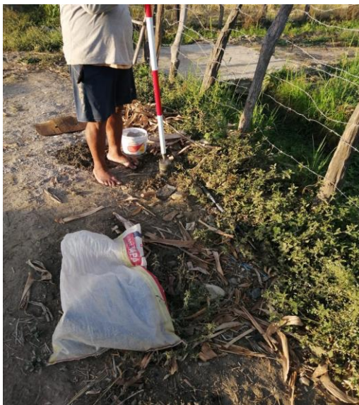
Imagen 2: BM 2, Monumentado con concreto.
