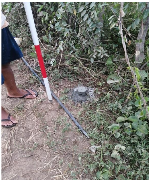
Imagen 2: BM 2, Monumentado con concreto.
