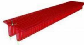
Gráfico 18. Discretización de la viga y losa de la superestructura
