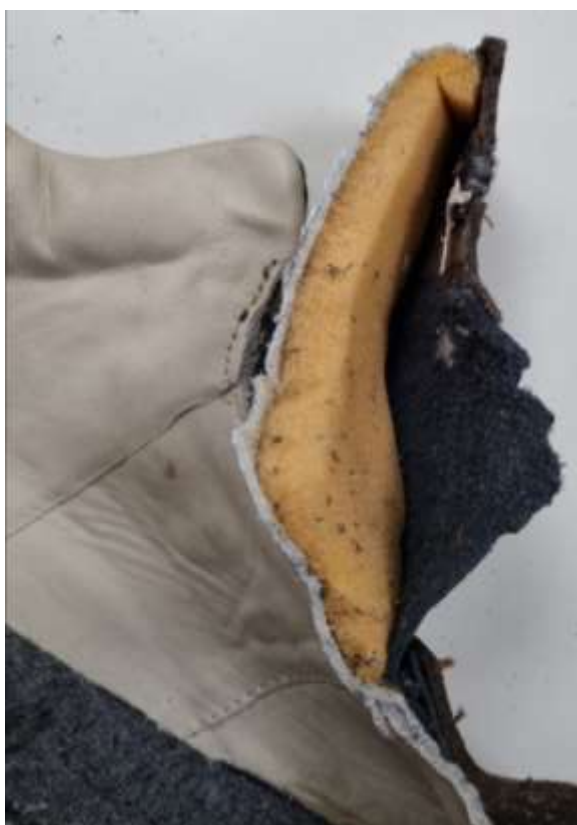
FUELLE: Tafilite integrado que no permite el ingreso del agua al interior del botín.
