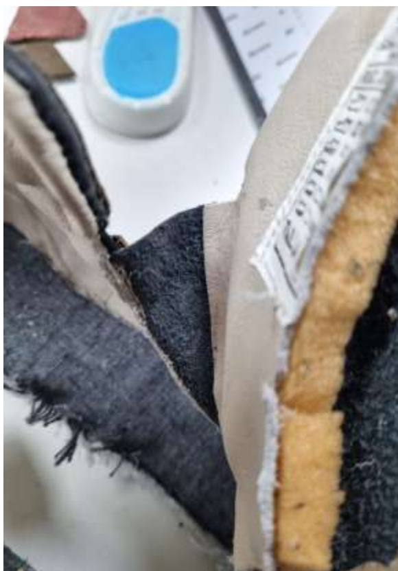
FUELLE: Tafilite integrado que no permite el ingreso del agua al interior del botín.
