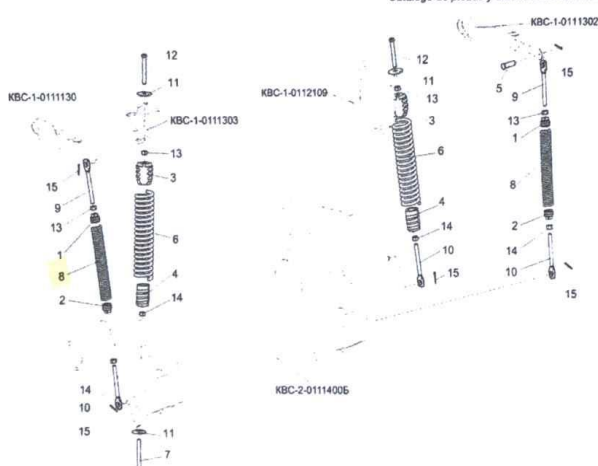
Dibujo 16 – Resortes del aparato alimentador
