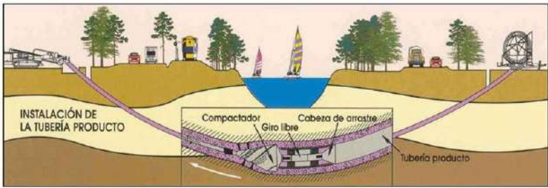
Imagen 16: Instalación de Tubería
