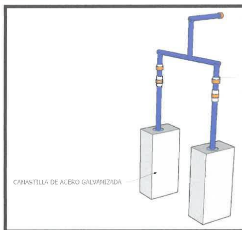
Canastilla de acero galvanizado de 5mm de separación entre varillas.
