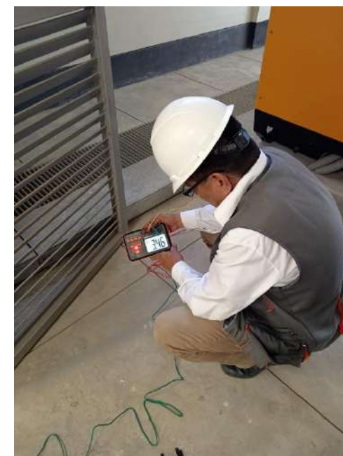
Fotografías N° 07: Sistema de puesta a tierra.
