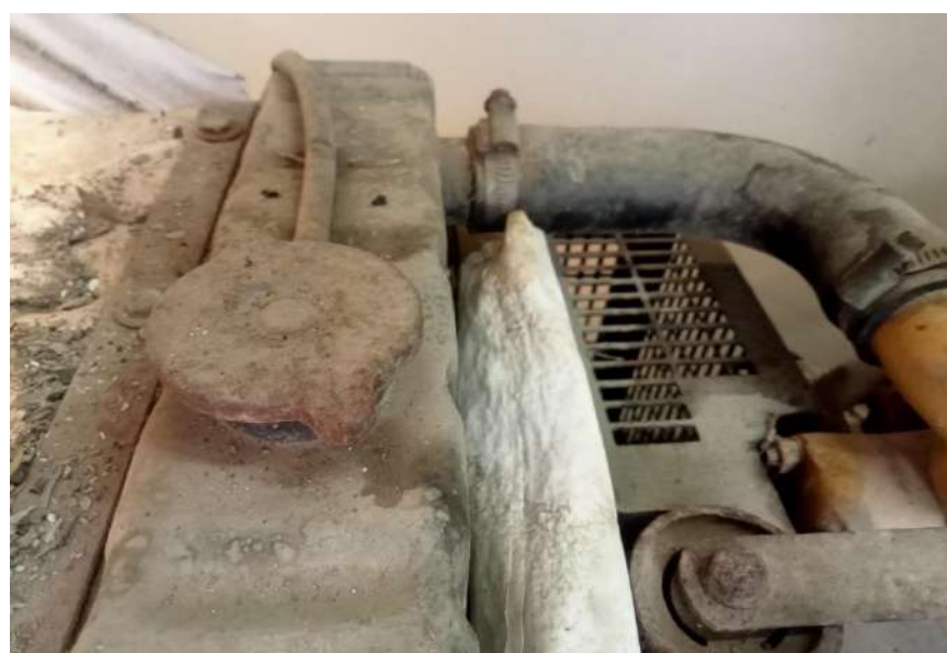
Fotografías N° 06: Tanque de combustible, mangueras, carcasa y ductos de expulsión de gases.
