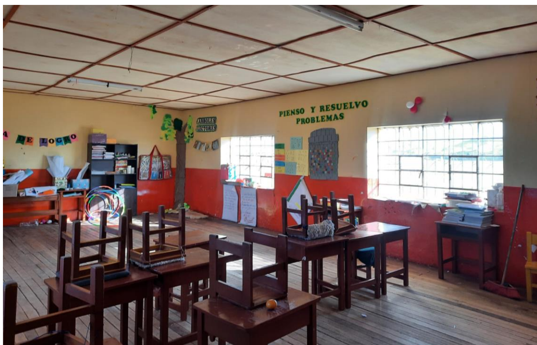
Imagen N°03: Interior del aula 1° y 2° grado, muros enlucidos con yeso, ventanas metálicas, falso cielo raso con triplay.
