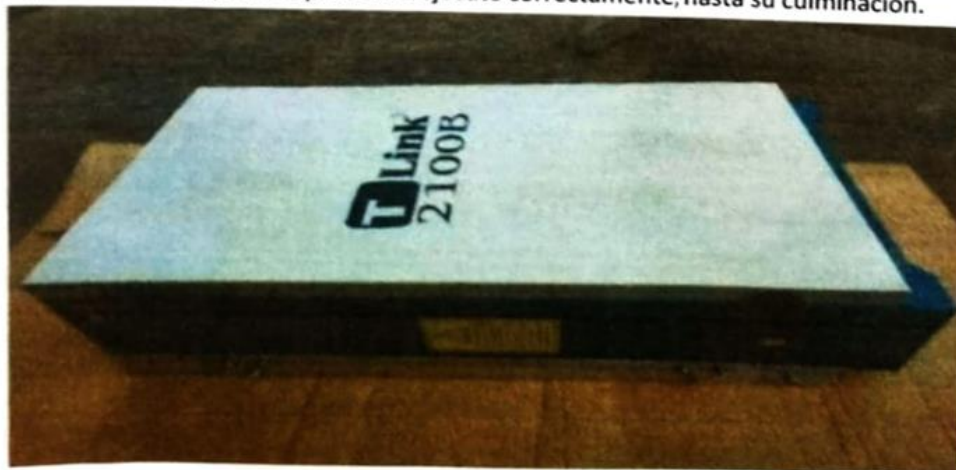
Detalle de equipo repetidor para tecnología 3G y 4G (Acorde a frecuencia del operador móvil)
