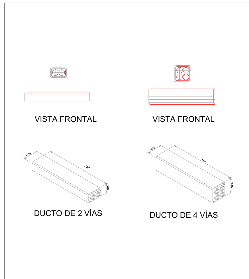
DETALLE ISOMETRICO DE DUCTOS DE CONCRETO DE 2 Y 4 VÍAS ESCALA: 1/50
