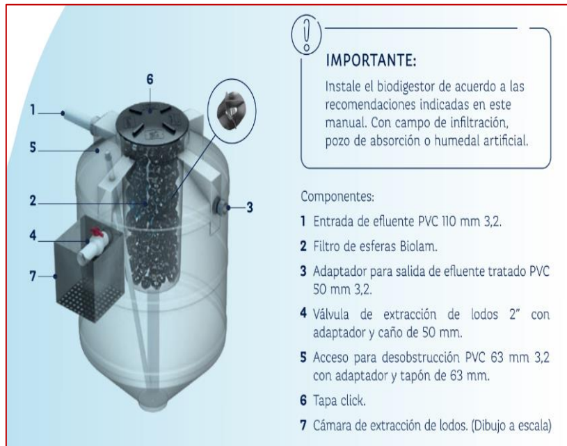
IMAGEN N° 11: COMPONENTES DEL BIODIGESTOR
