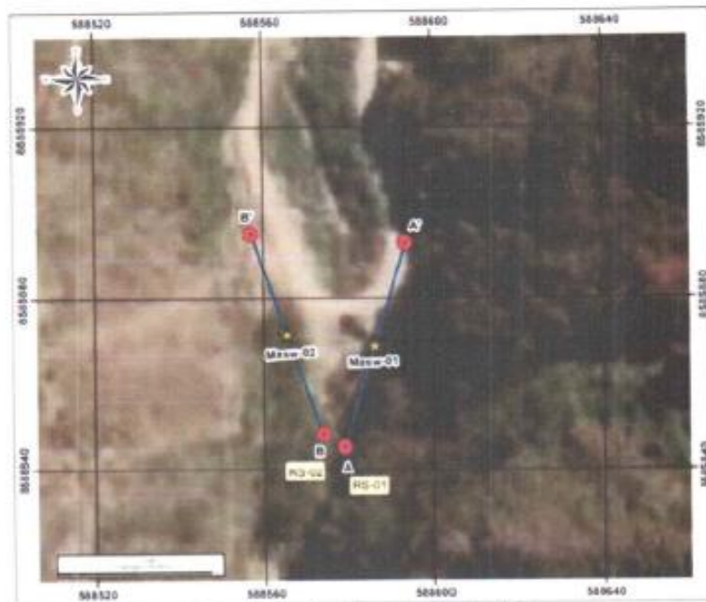
Figura 1: Ubicación de líneas de refracción sísmica. Fuente: Informe Técnico de prospección geofísica (HIDROGEOINGENIERIA).
