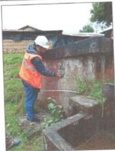
Realización del ensayo de esclerómetro.
