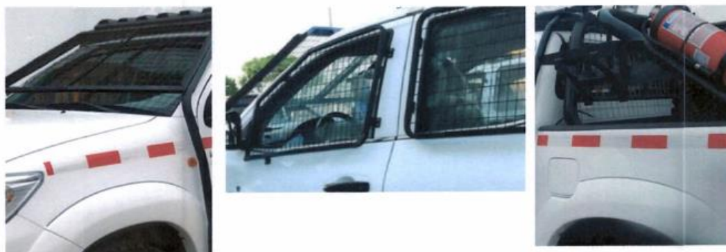
Mallas de seguridad en parabrisas delantero y posterior, y lunas laterales, barra antivuelco y portaextintor (imagen referencial).
