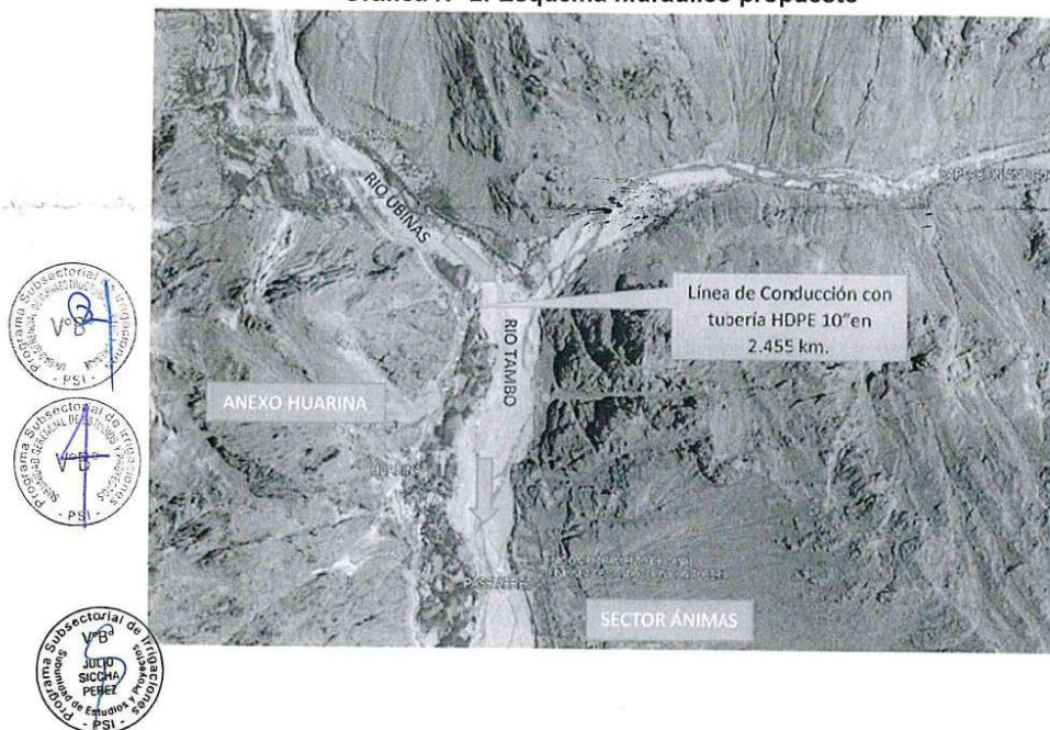
Gráfica N° 2: Esquema hidráulico propuesto
