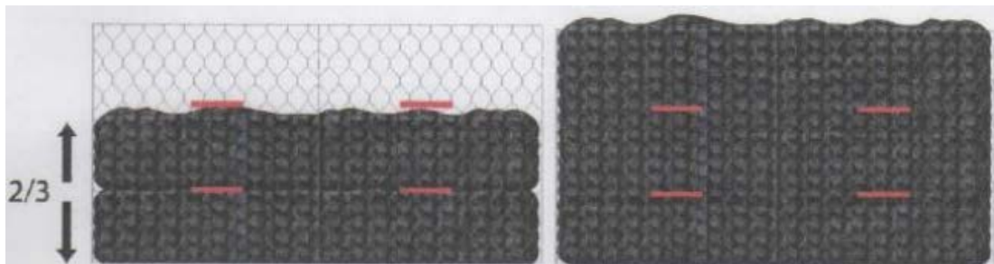
Gráfico N° 28 – Posición de los tensores en Gavión.
