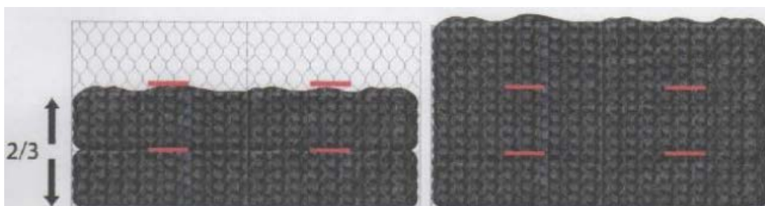
Gráfico N° 13 – Posición de los tensores en Gavión.
