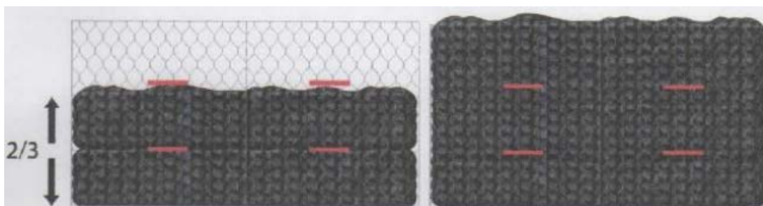
Gráfico N° 22 – Posición de los tensores en Gavión.
