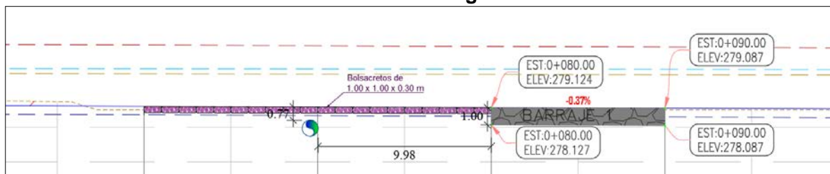
Imagen N° 05 – Perfil longitudinal con bolsacretos y barraje en eje de río Chiangos.
