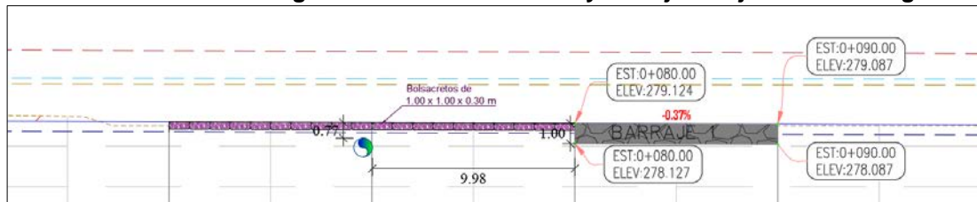
Gráfico N° 23 – Perfil longitudinal con bolsacretos y barraje en eje de río Chiangos.
