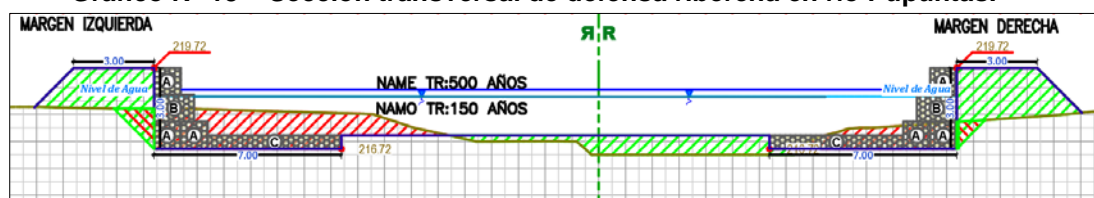
Gráfico N° 13 – Sección transversal de defensa ribereña en río Pupuntas.
