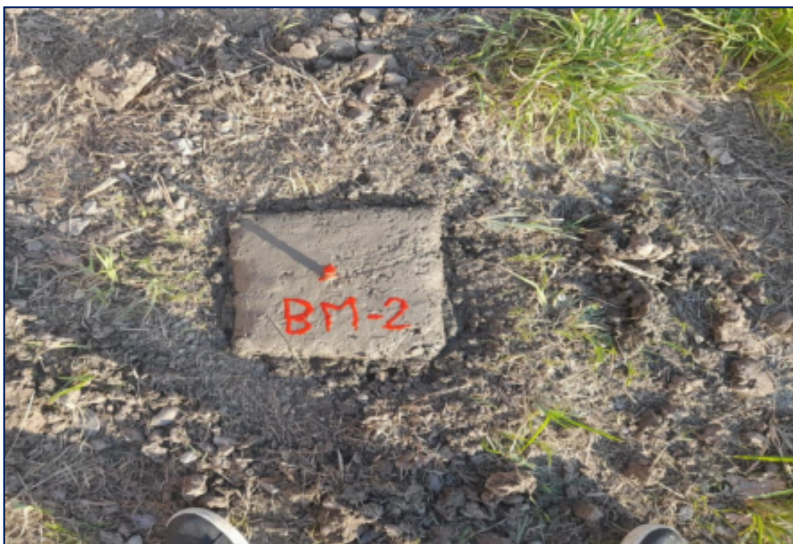
Ilustración N° 06: Foto de Colocación de BMs
