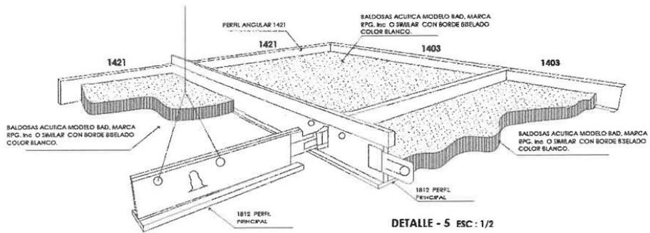
**ENSAMBLE DE ESTRUCTURA DE PERFILES DE ALUMINIO CON PLANCHAS DE FIBRA DE VIDRIO DE 60\*60**
