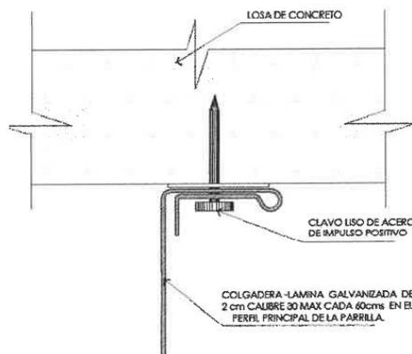
**FIJACION DE CIELO RASO SUSPENDIDO A VIGUETA LOSA O VIGA DE CONCRETO**
