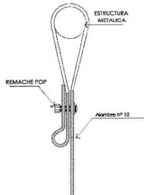
**FIJACION DE CIELO RASO SUSPENDIDO A ESTRUCTURA METALICA**
