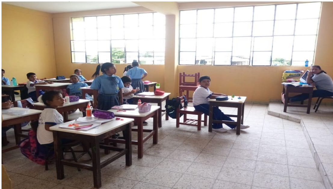
IMAGEN N° 09: el piso de las aulas es de loseta, el cual se encuentra en regular estado de conservación. Las paredes son de ladrillo (aparejo de soga) tarrajeados y pintados. Confinados con columnas y vigas. No existe juntas de dilatación muro – columna.
