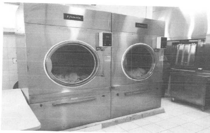
02 secadoras de ropa tipo centrifugo de 30 Kilos de capacidad cada una
