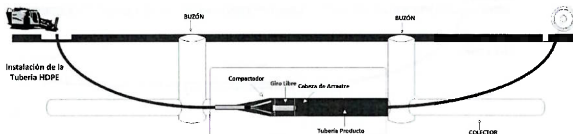
Ilustración 4. Instalación de tubería
