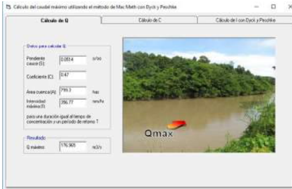
Gráfico N° 26: Cálculo para el caudal de diseño – Método Mac-Math ( T_r = 500 años)
