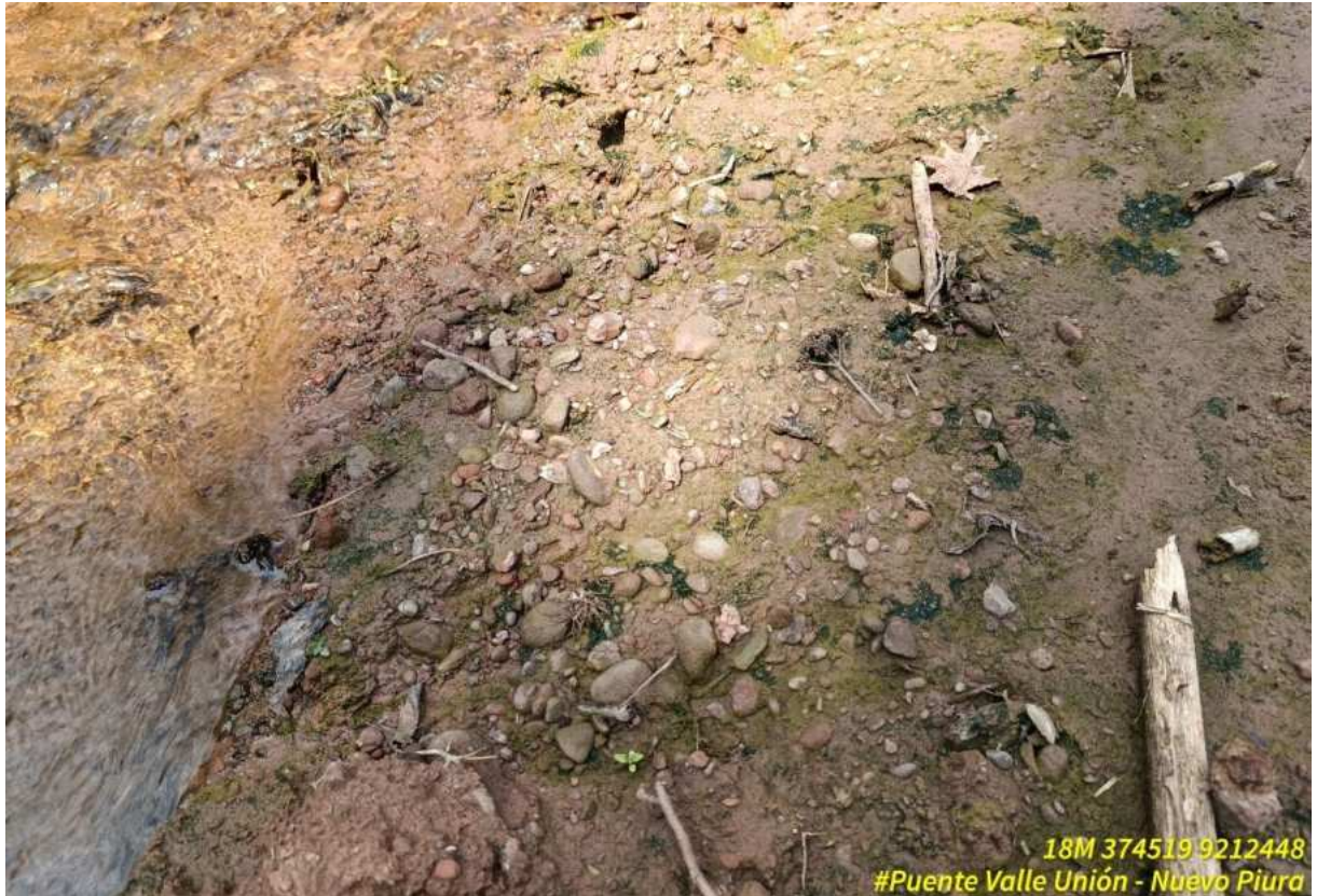
Foto 8: Depósitos fluviales de gravas medianas con arenas y arcillas.
