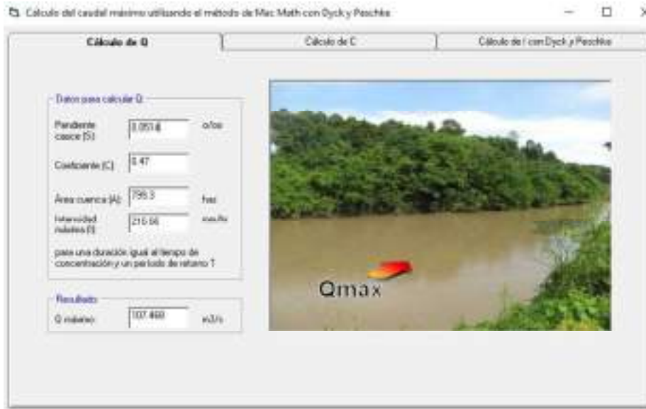
Gráfico N° 25: Cálculo para el caudal de diseño – Método Mac-Math ( T_r = 140 años)
