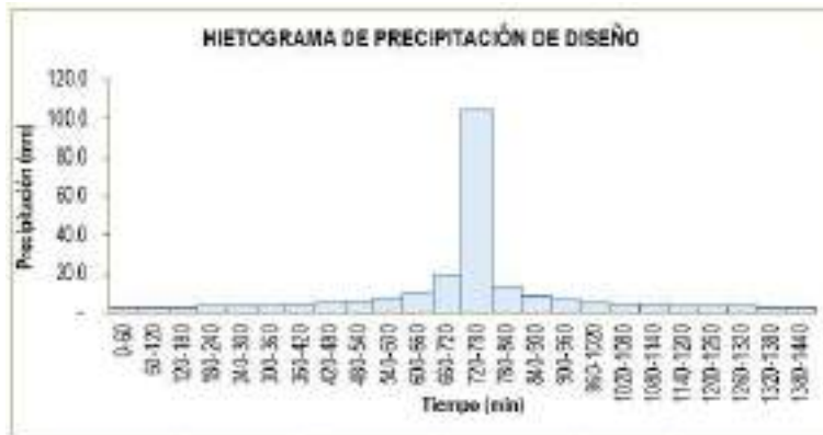
Gráfico N° 19: Hietograma de Diseño utilizando el Método del Bloque Alterno ( T_r = 500 años)
