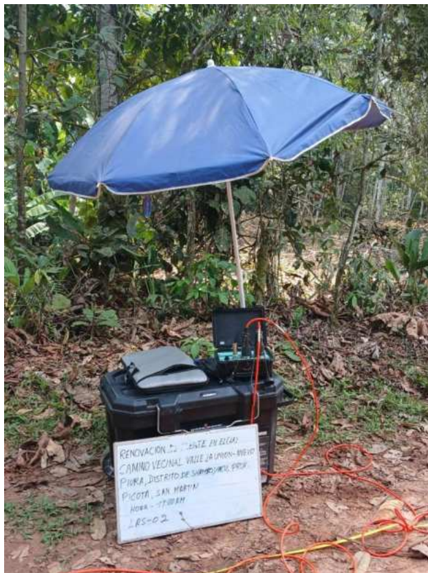
Figura 6. Instalación de sismógrafo Pasi.
