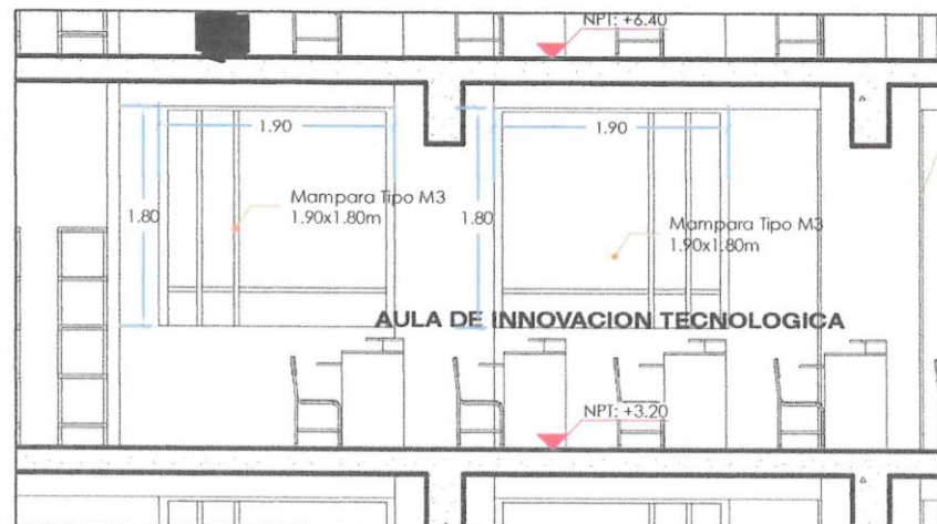
DETALLE DE ELEVACION DEL BLOQUE III, INDICANDO TIPO DE MAMPARA M-3 (1ER A 3ER NIVEL)
