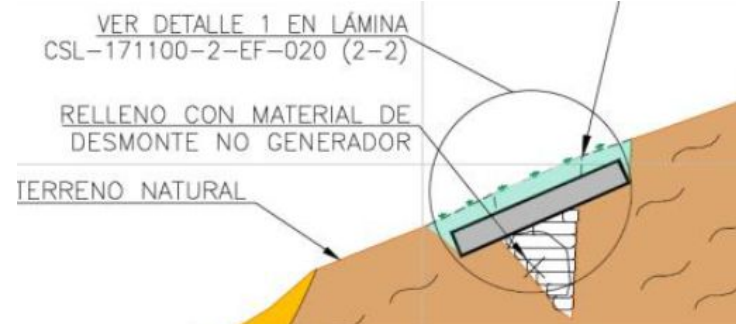
Construcción de losa de concreto armado y relleno con material de topsoil
