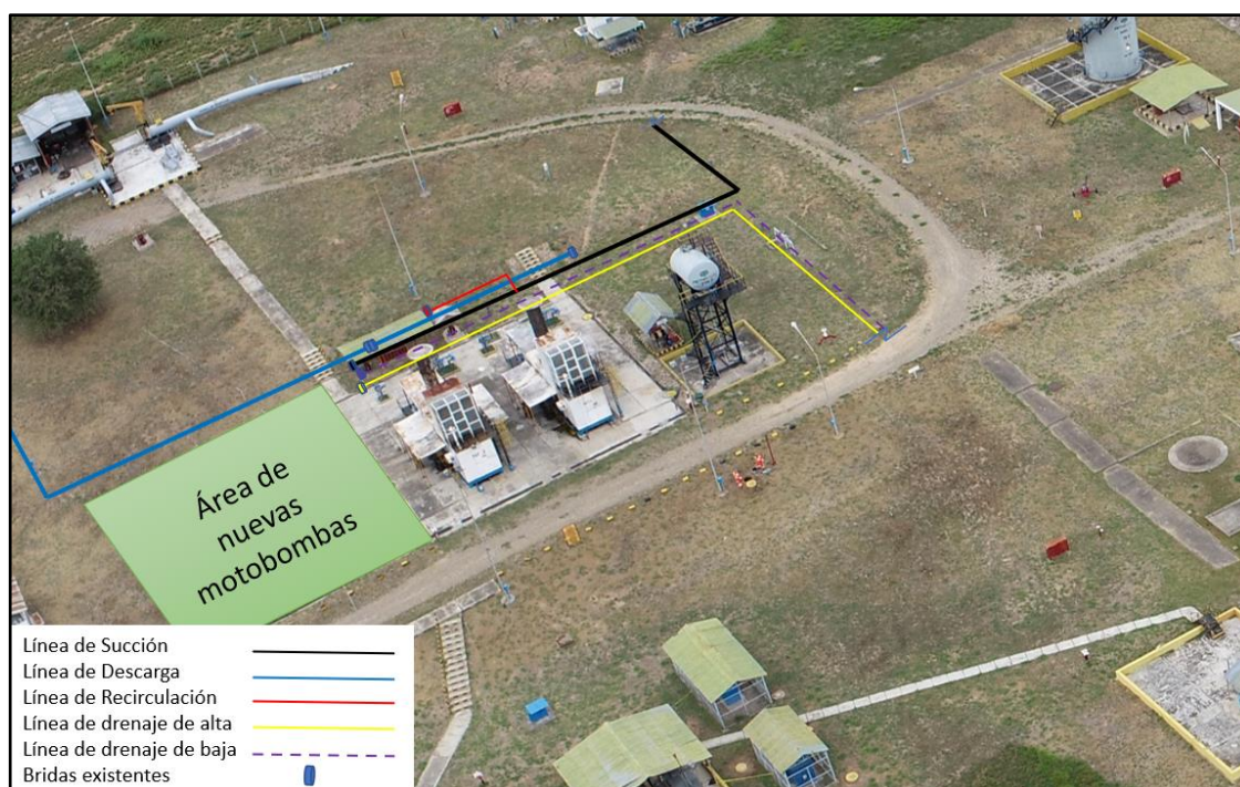
Figura N°5. Recorrido de líneas matrices del sistema de bombeo de Estación 7
