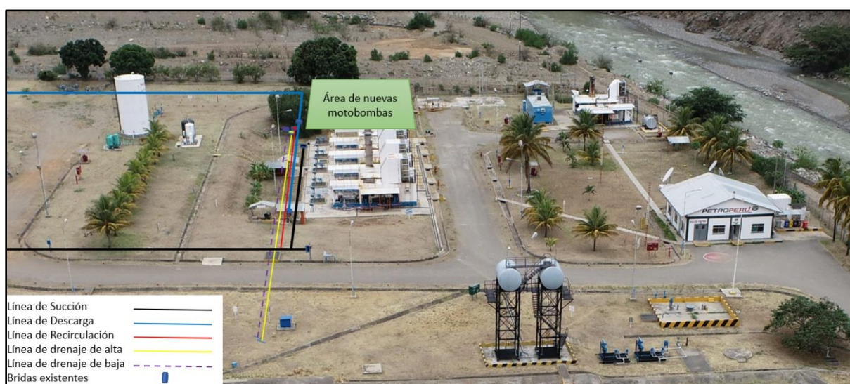
Figura N°7. Recorrido de líneas matrices del sistema de bombeo de Estación 9
