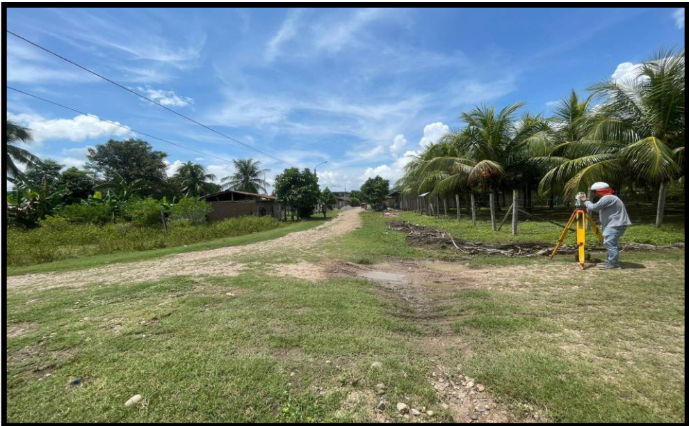
JR. SARGENTO LORES C-01: Se aprecia que no existen características de veredas urbanas que conecta las vías urbanas. No existe cunetas para los drenajes pluviales. Vías con un afirmado muy desgastado. Arborización que enriquecen el perfil urbano.
