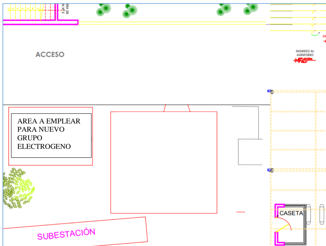
Figura N° 1: Ubicación del grupo electrógeno.
