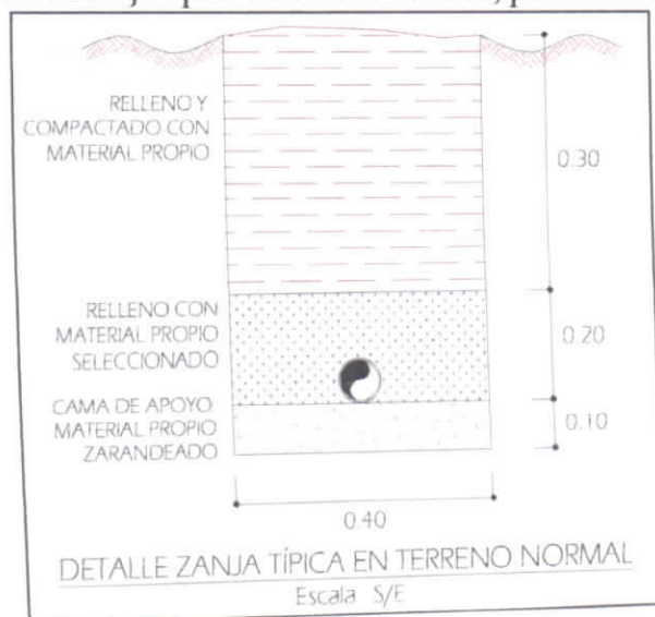
Gráfico 8. Detalle de zanja típica en terreno normal, para línea de conducción.
