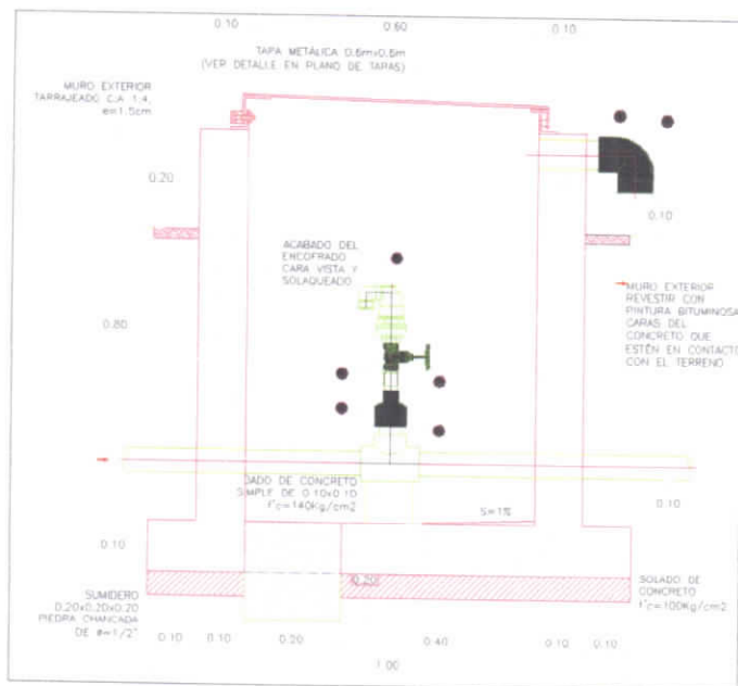
Gráfico 47. Válvula de Aire en Red de Distribución – Sistema 03.
