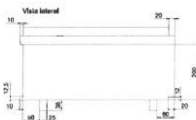
Ilustración 10: Cuerpo del portanúcleo, vista lateral.
