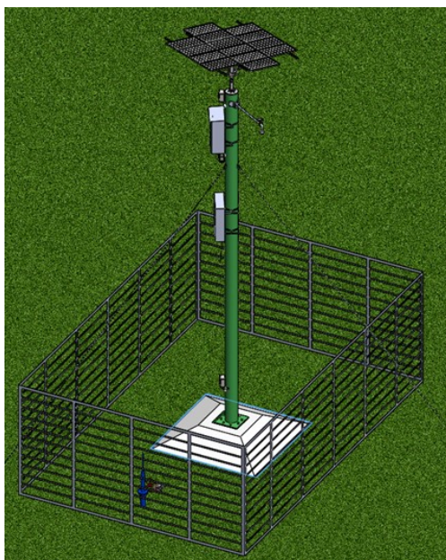
Esquema Referencial del Poste de transmisión y cerco perimétrico Instalado.
