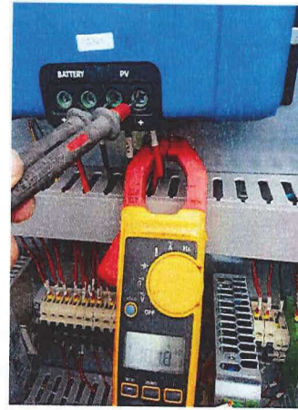
Foto N°19: Tensión de ingreso a regulador de carga-Paneles: 101.8 Vdc
