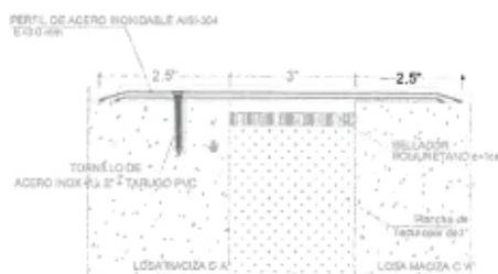
DETALLE 07 TAPAJUNTA ENCUESTRO PISO - PISO
