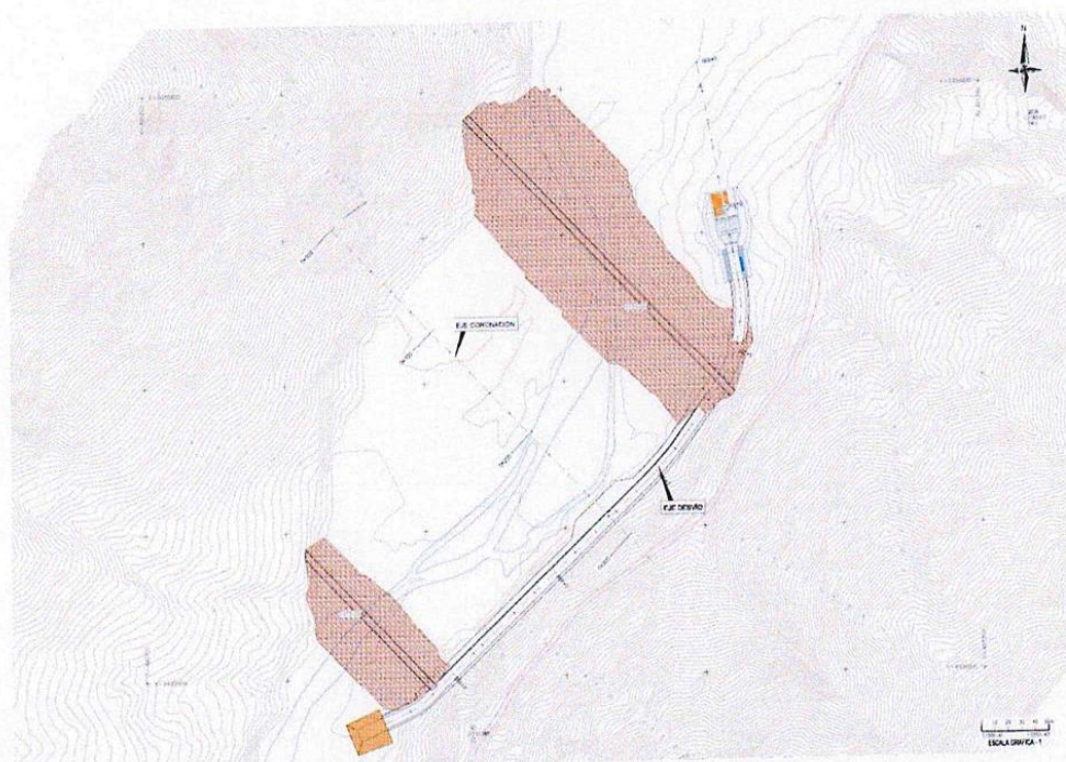
Figura n° 11. Trazado en planta obra de desvío
