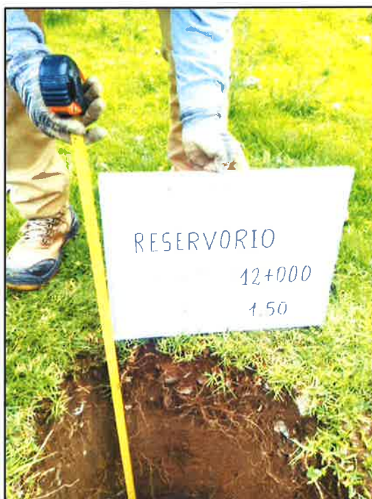
Fotografía N° 46: Vista de la Calicata, realizado dentro del área donde se propone la ubicación del reservorio.
