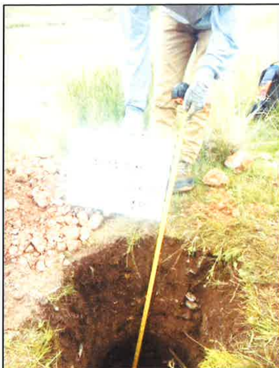
Fotografía N° 45: Vista de la calicata 01, realizado mediante excavación manual, una profundidad de 1.50 m, ubicado en la captación KM 00+000.
