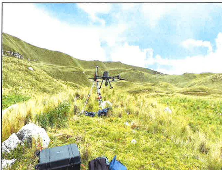
Fotografía N° 29: Vista de la elevación y lanzamiento del dron RTK, para el levantamiento fotogramétrico. Realizando el VUELO 1.
