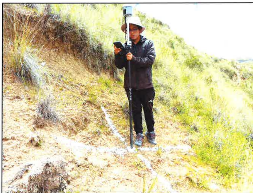
Fotografía N° 28: Registro y toma de datos del PC-05, ubicado cerca al BM 05.
