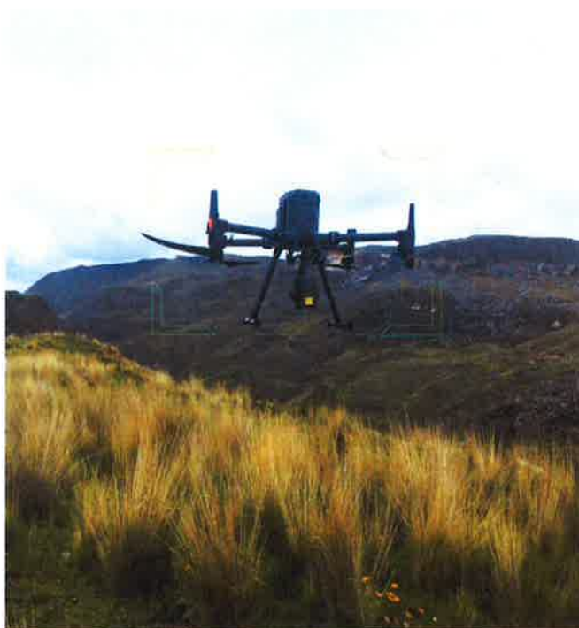
Fotografía N° 36: Lanzamiento y vuelo del dron RTK, para levantamiento fotogramétrico, VUELO 4.
