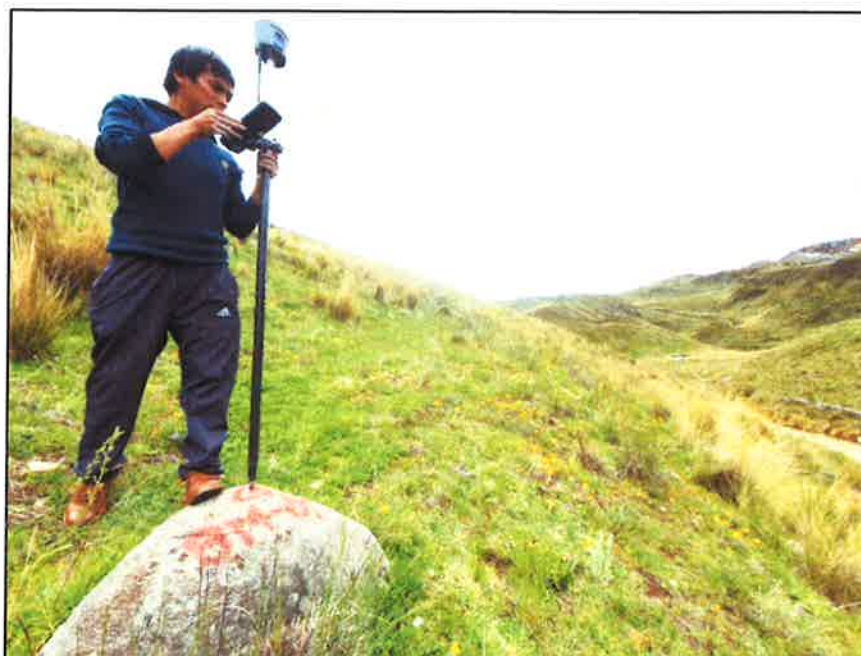
Fotografía N° 19: Registro y toma de datos del BM-01, lo cual se encuentra sobre una roca fija.
