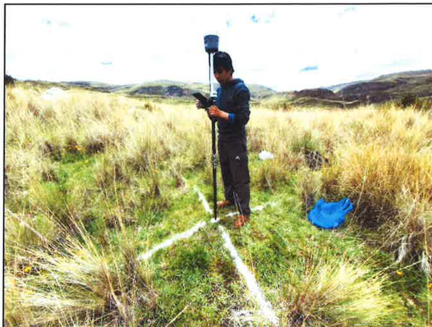
Fotografía N° 23: Registro y toma de datos del PC-01, ubicado en una superficie visible para el levantamiento fotogramétrico.
