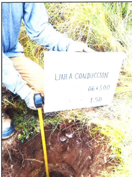
Fotografía N° 47: Vista de la Calicata 14, realizado manualmente en la línea de conducción KM 06+500.
