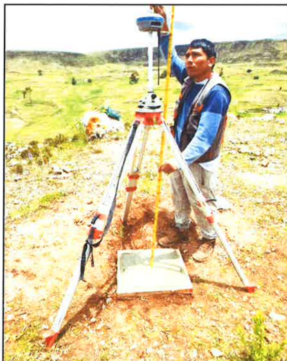
Fotografía N° 12: Medición de la altura del equipo GPS diferencial, para el registro del punto Geodésico 1002044.
