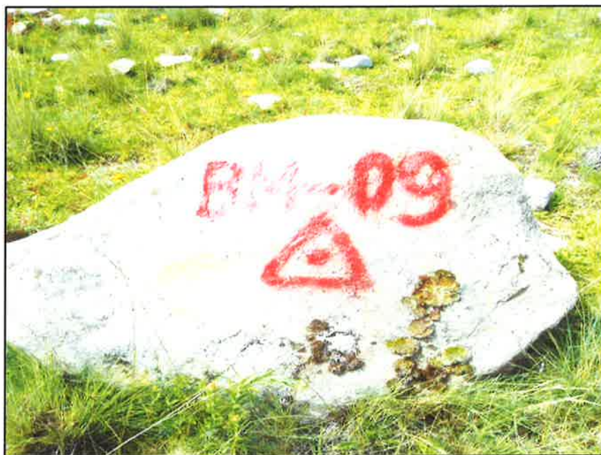
Fotografía N° 38: Vista y señalización del BM-09, ubicado sobre una roca fija, al lado de la línea de conducción proyectada.
