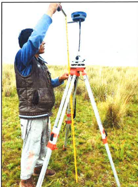
Fotografía N° 33: Medición de altura del equipo de GPS Diferencial BASE 2 para el registro de puntos de control y levantamiento fotogramétrico.
