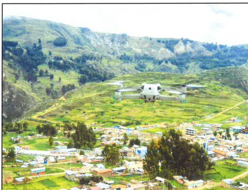
Fotografía N° 42: Vista del vuelo y lanzamiento del dron DJI, para el levantamiento fotogramétrico. Realizando el VUELO 14.
