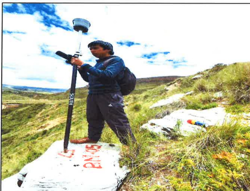
Fotografía N° 25: Registro y toma de datos del BM-05, el cual se encuentra sobre una roca fija.
