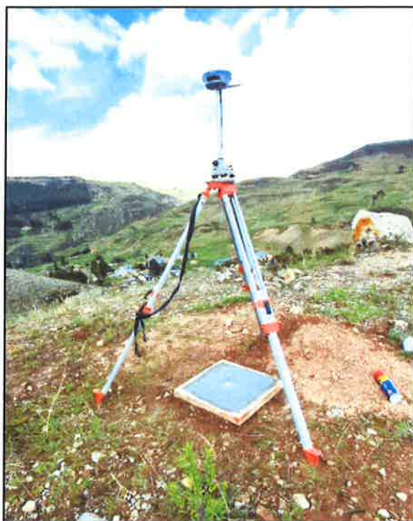
Fotografía N° 13: Vista del equipo GPS Diferencial estacionado y registrando datos del punto Geodésico 1002044.
