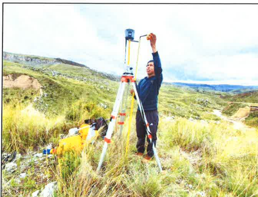
Fotografía N° 17: Medición de altura del equipo de GPS Diferencial BASE 1 para el registro de puntos de control.
