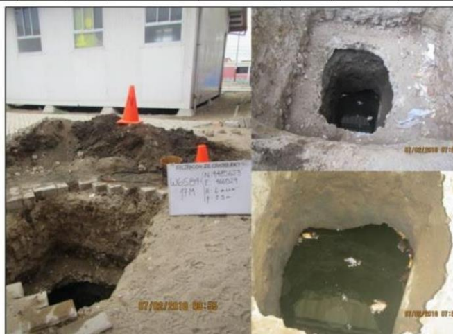
Figura 2-1. Fotografías de la excavación con presencia de hidrocarburos obtenidos durante la visita de reconocimiento el 7 de febrero de 2018.
